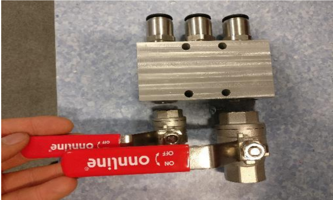
Kuva 3 Jakotukki johon liitetty 3 kpl pistoliittimiä ja yksi sulkuventtiili, joka tulee pääputkelta, ja toinen pienempi sulkuventtiili poistoletkua varten.
