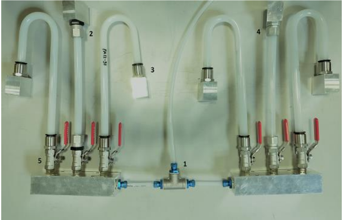
Kuva 10 1. Pieni karatyypin liitin 5 kpl 2. Suuri karatyypin liitin 2 kpl 3. Pistoliitin 8 kpl 4. Suuri karatyypin liitin 2 kpl 5. Pallosulkuventtiili 6 kpl.
