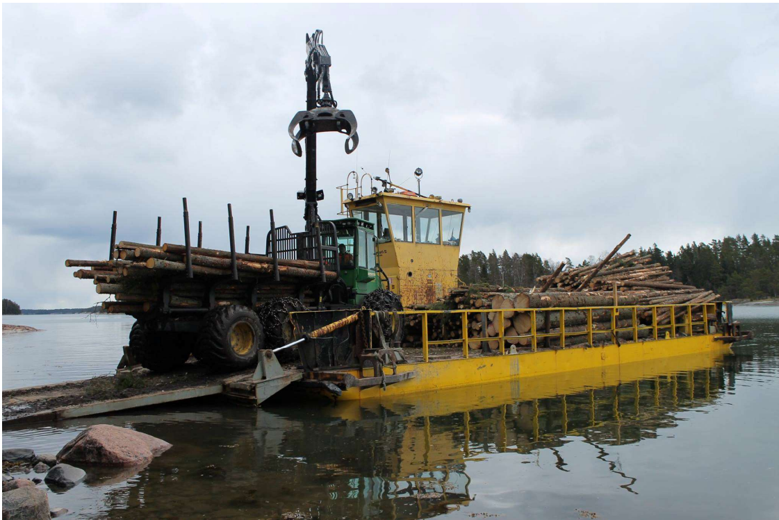
Bild 3. På bilden lastar skotarföraren virket med 180 graders vinkel på pråmen. Foto Jasmine Winqvist.
