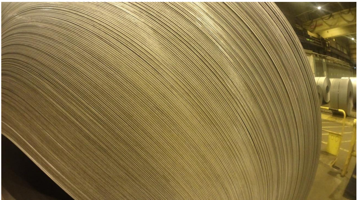
Kuva 49 Hoitopuolen reunaleikkauksen silmämääräinen tarkastus
