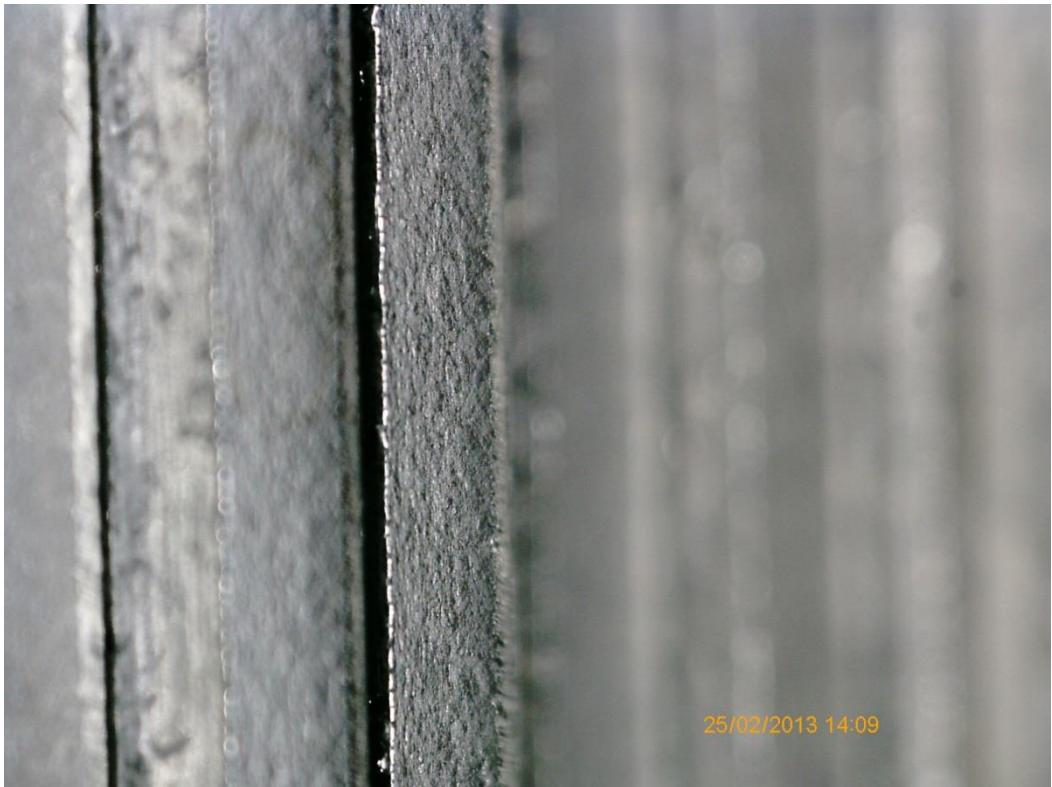
Kuva 30 Peittauksen hoitopuolen reunan sahalaita
