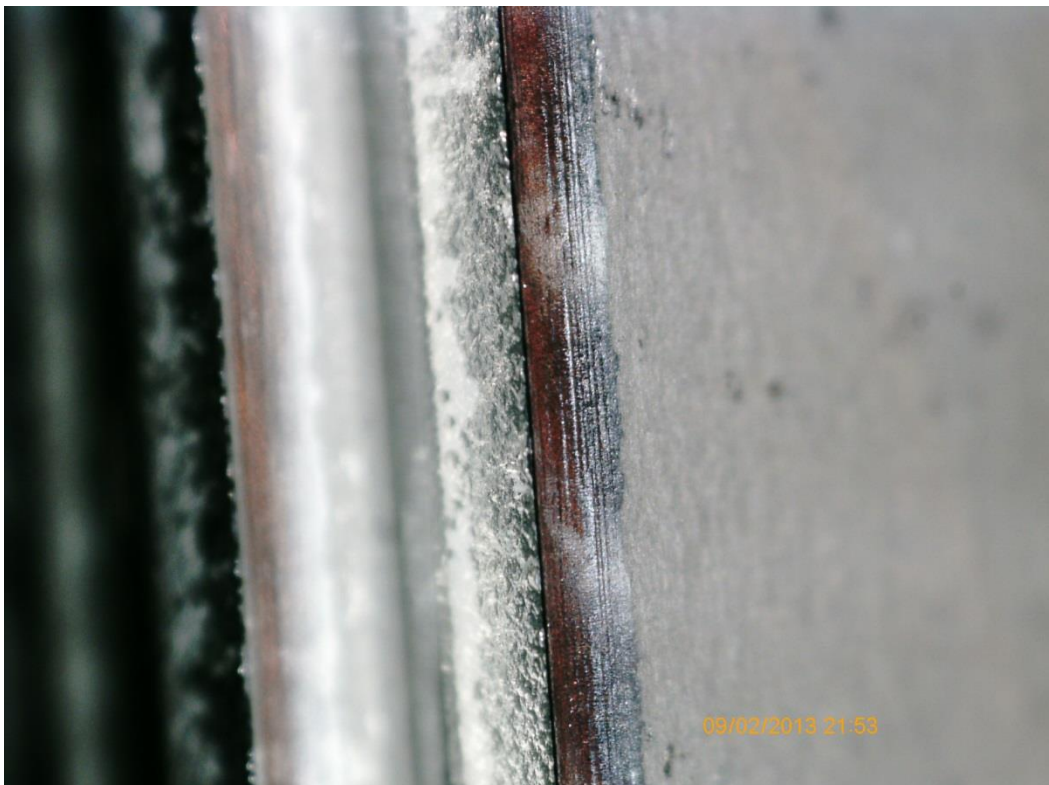
Kuva 53 Hoitopuolen tasainen murtuminen
