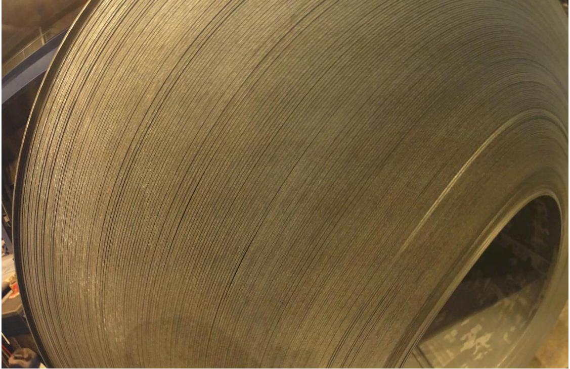
Kuva 19 Kelojen käyttöpuolen reunaleikkausjälki silmämääräisesti
