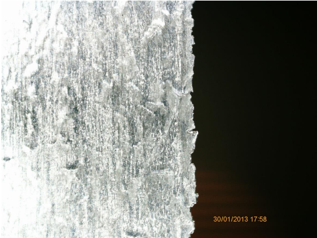
Kuva 47 Peittauksen käyttöpuoleisen reunan sahalaita
