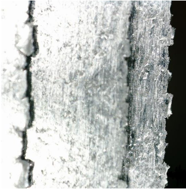
Kuva 16 Purseisen reunaleikkausjäljen kylmävalssaamisesta aiheutuva sahalaita
