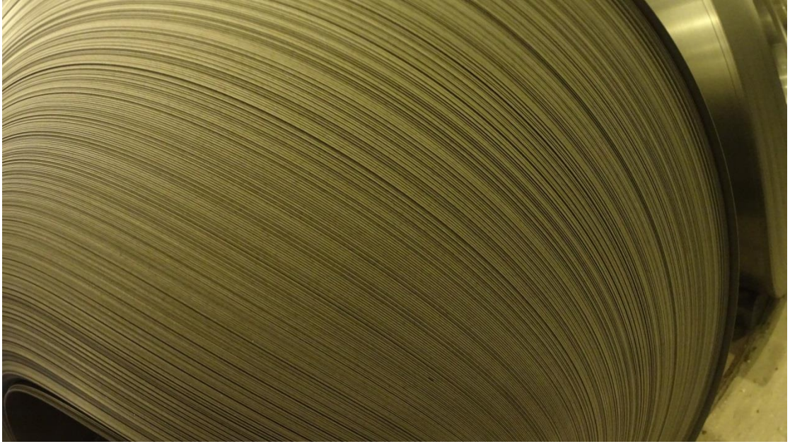
Kuva 58 Peittauksen käyttöpuolen reunan silmämääräinen tarkastus
