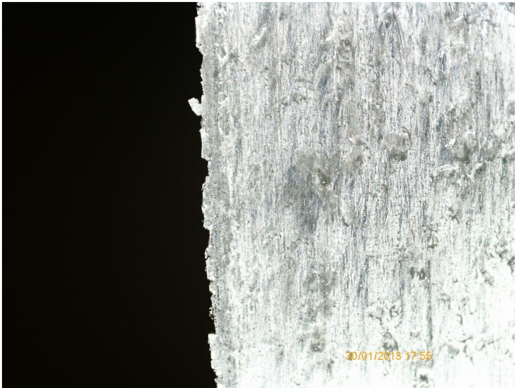
Kuva 46 Peittauksen hoitopuoleisen reunan sahalaita
