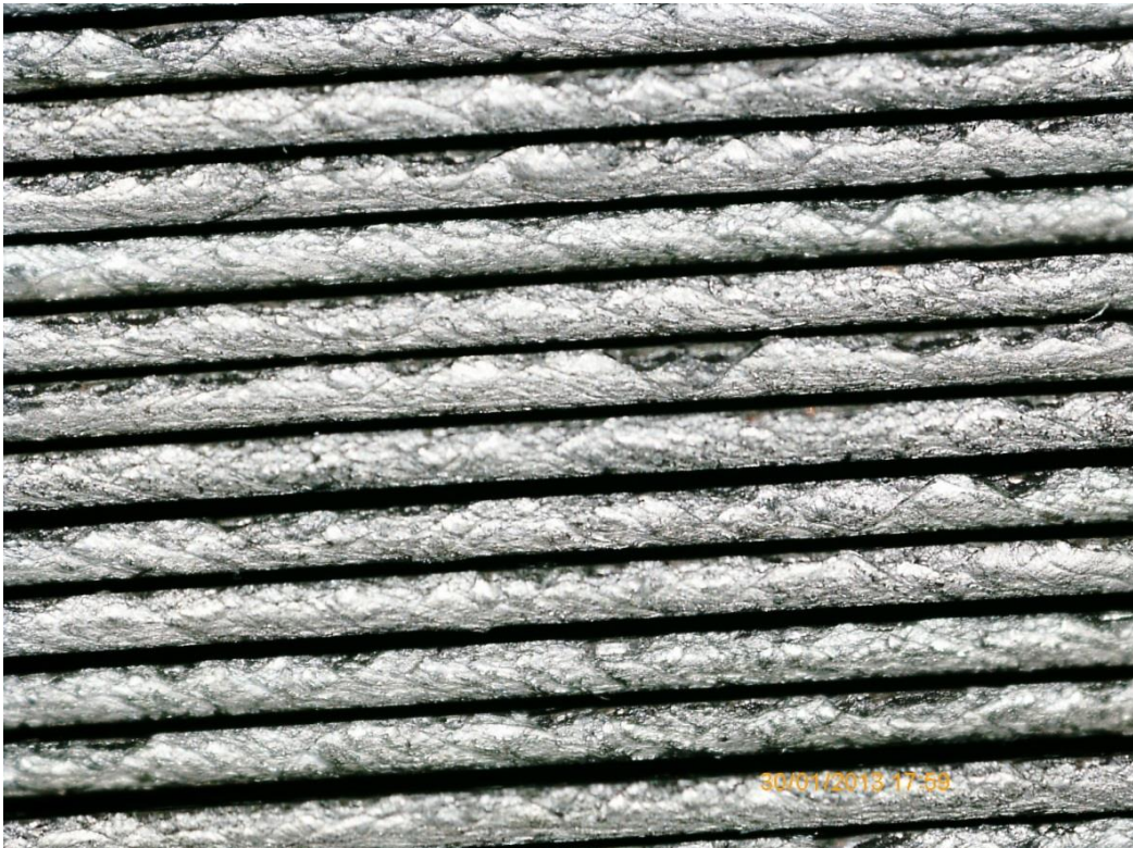
Kuva 44 Peittauksen hoitopuolen reuna kylmävalssauksen jälkeen
