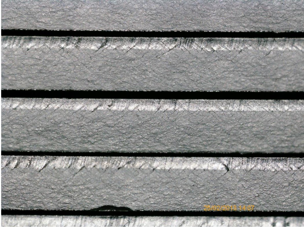
Kuva 29 Peittauksen hoitopuolen reunaleikkausjäljen muutos
