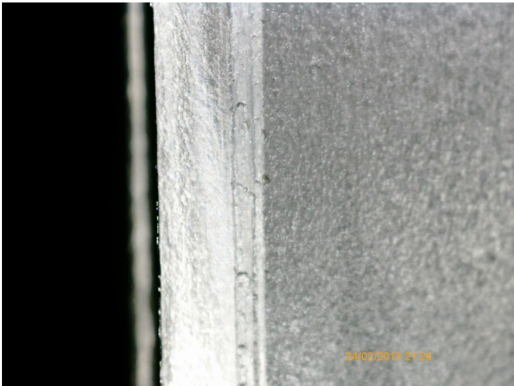
Kuva 22 Hoitopuolen leikkauksessa tapahtunut teräksen liukuminen
