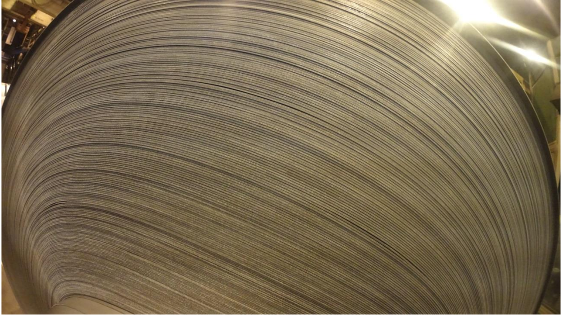
Kuva 50 Käyttöpuolen reunaleikkauksen silmämääräinen tarkastus
