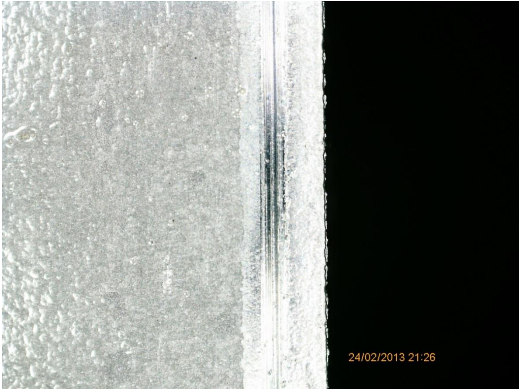
Kuva 25 Käyttöpuolen epätasainen murtuminen
