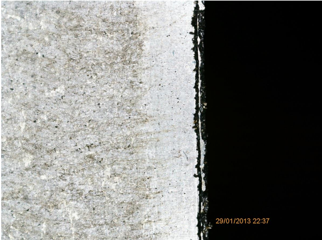
Kuva 37 Hoitopuolen leikkauksessa tapahtunut teräksen liukuminen
