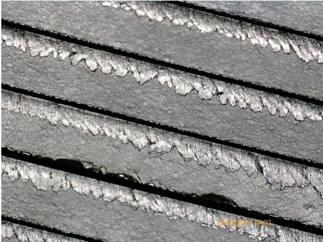
Kuva 31 Peittauksen käyttöpuolen reunaleikkausjäljen muutos
