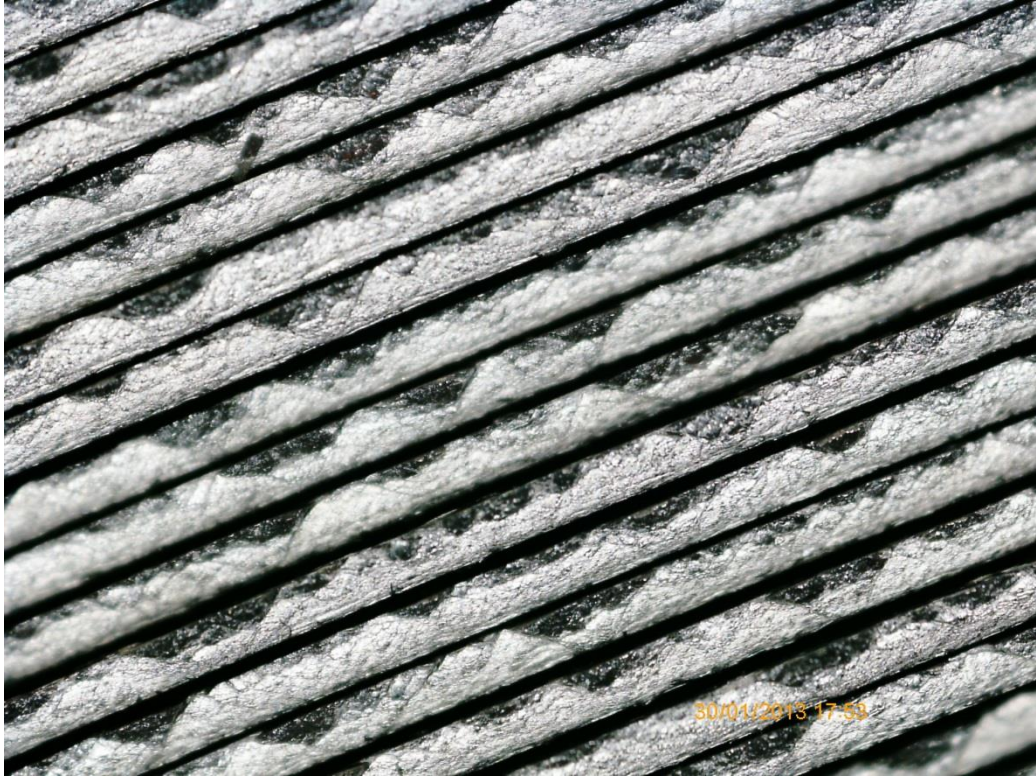
Kuva 45 Peittauksen käyttöpuolen reuna kylmävalssauksen jälkeen
