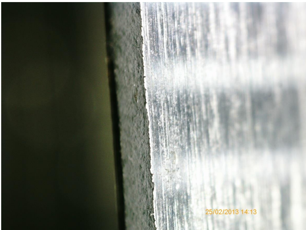
Kuva 32 Peittauksen käyttöpuolen sahalaita
