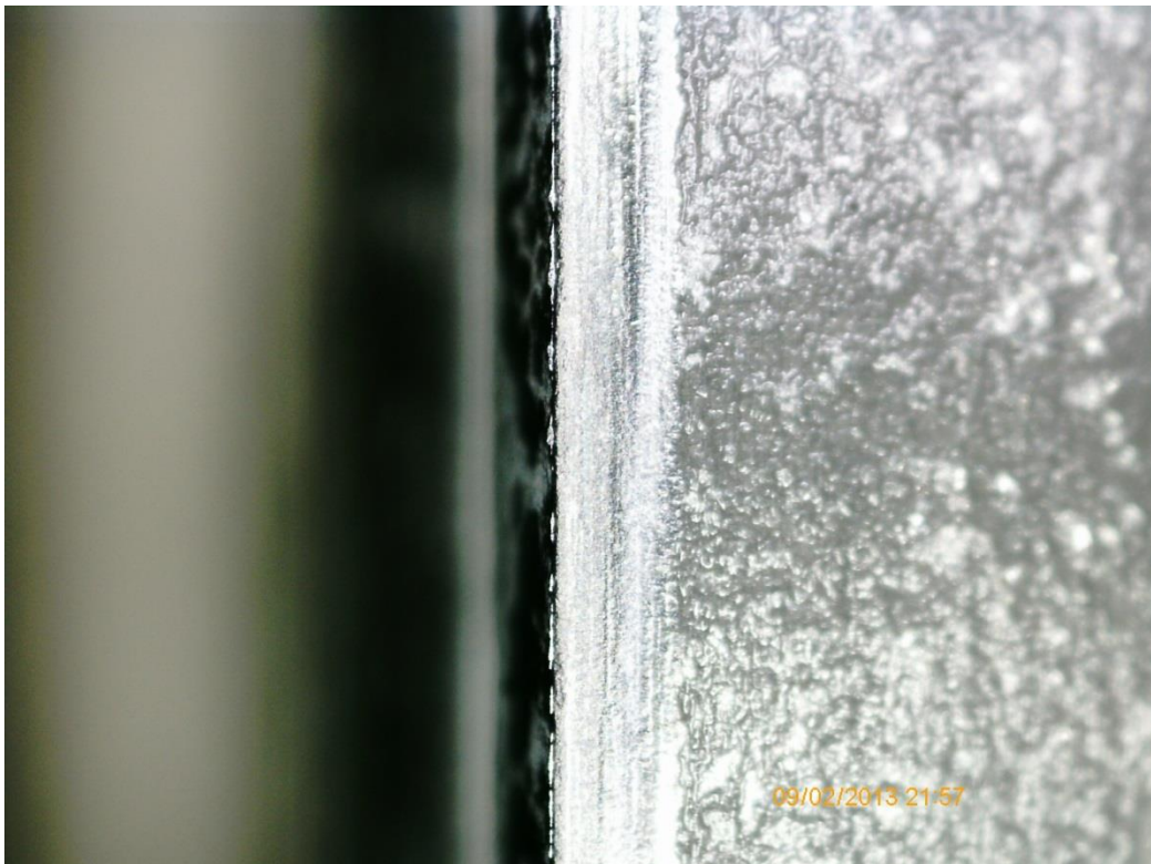
Kuva 55 Käyttöpuolen epätasainen murtuminen, purse
