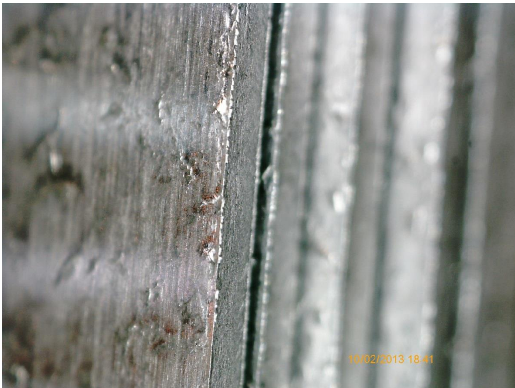
Kuva 62 Käyttöpuolen reunan mikroskooppikuva heikon purseen valssautumisesta
