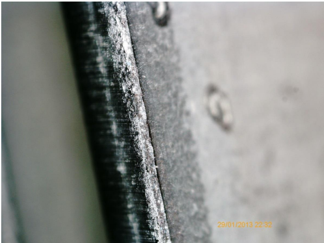
Kuva 38 Hoitopuolen leikkausjäljen purse
