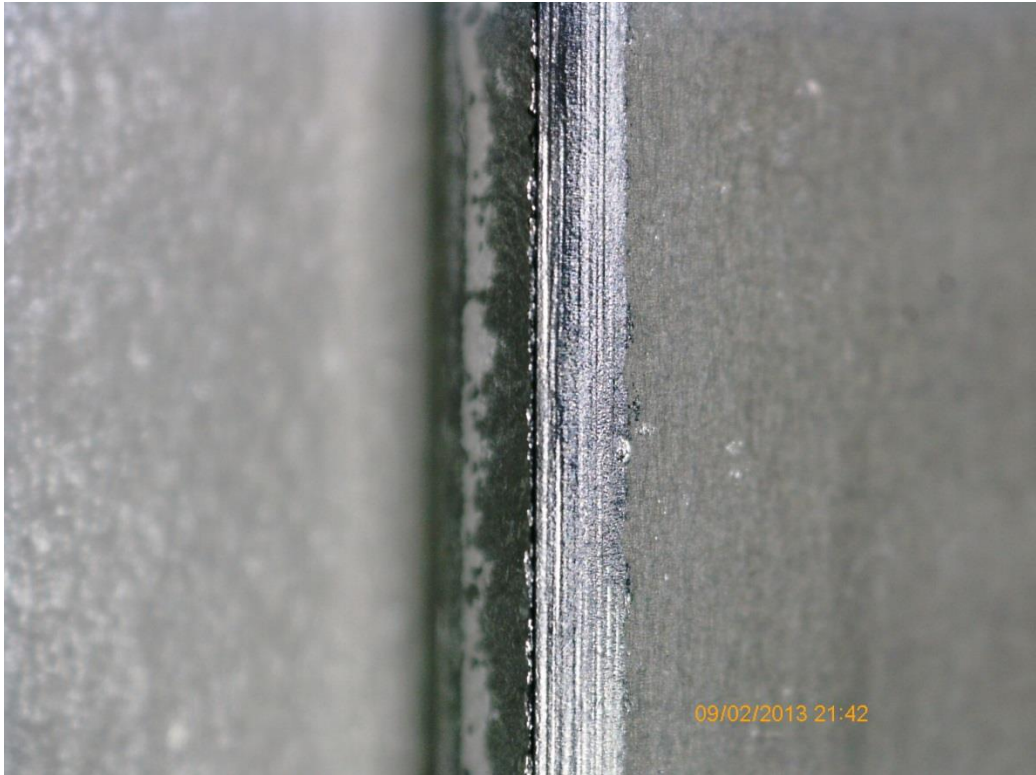
Kuva 52 Hoitopuolen epätasainen murtuminen, purse
