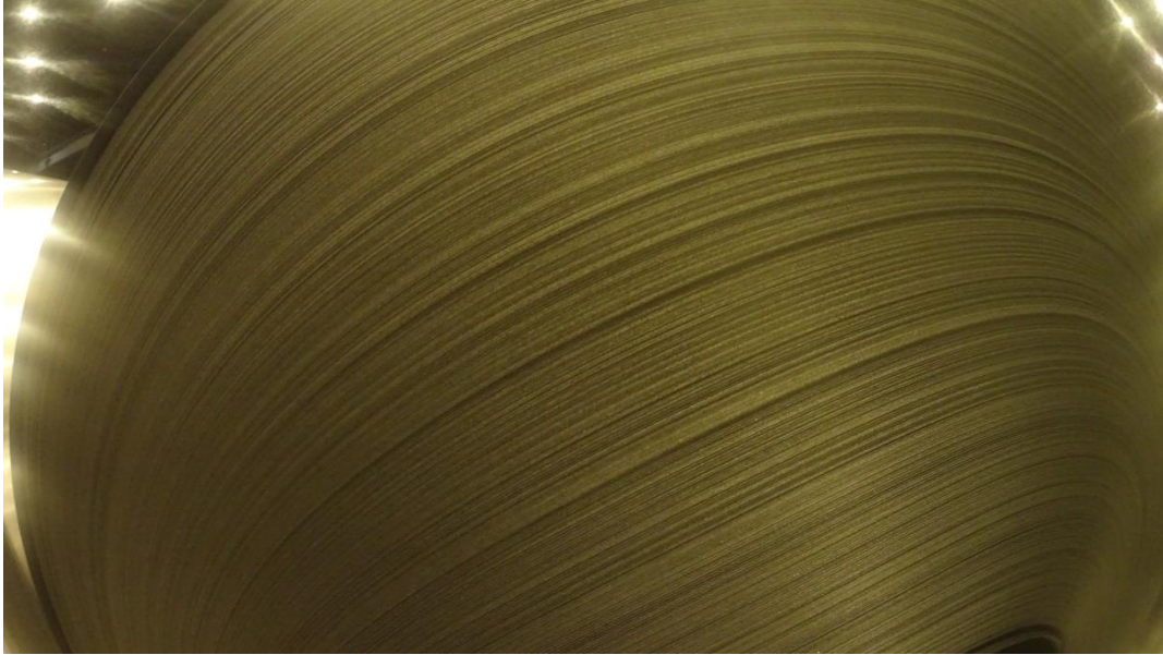
Kuva 43 Peittauksen hoitopuolen reuna silmämääräisesti katsottuna
