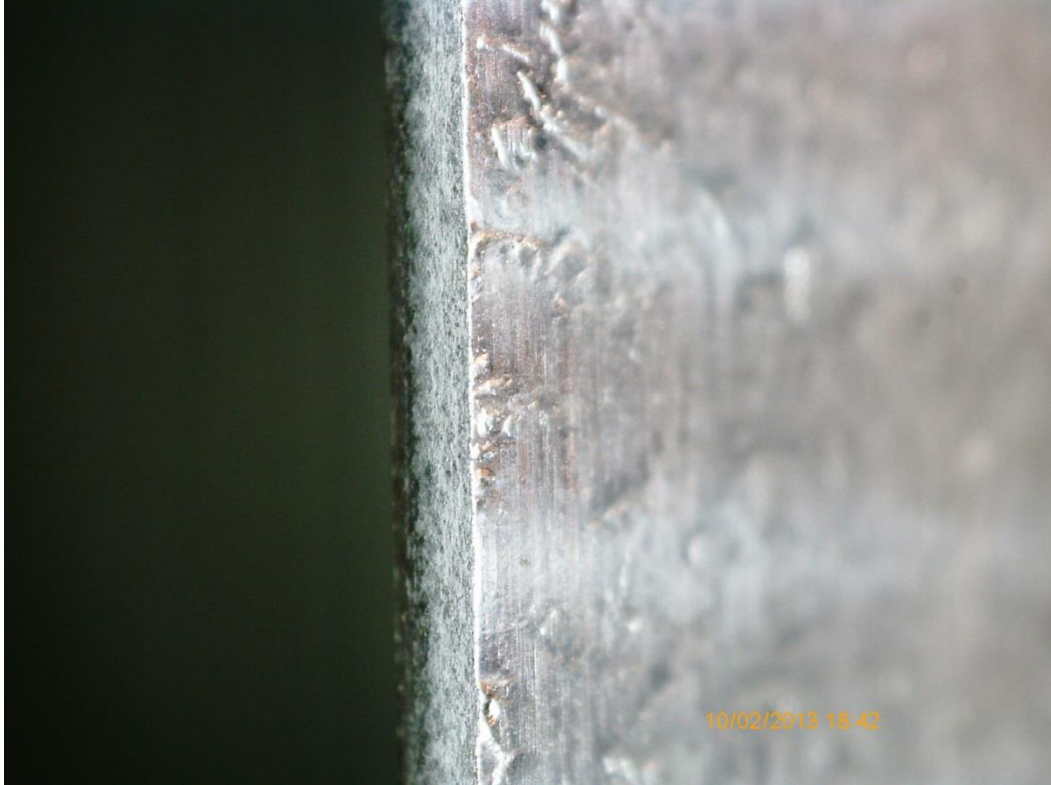
Kuva 60 Peittauksen hoitopuolen purseen valssatuminen
