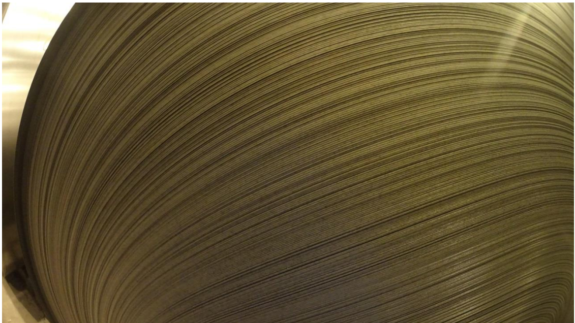
Kuva 57 Peittauksen hoitopuolen reunan silmämääräinen tarkastus
