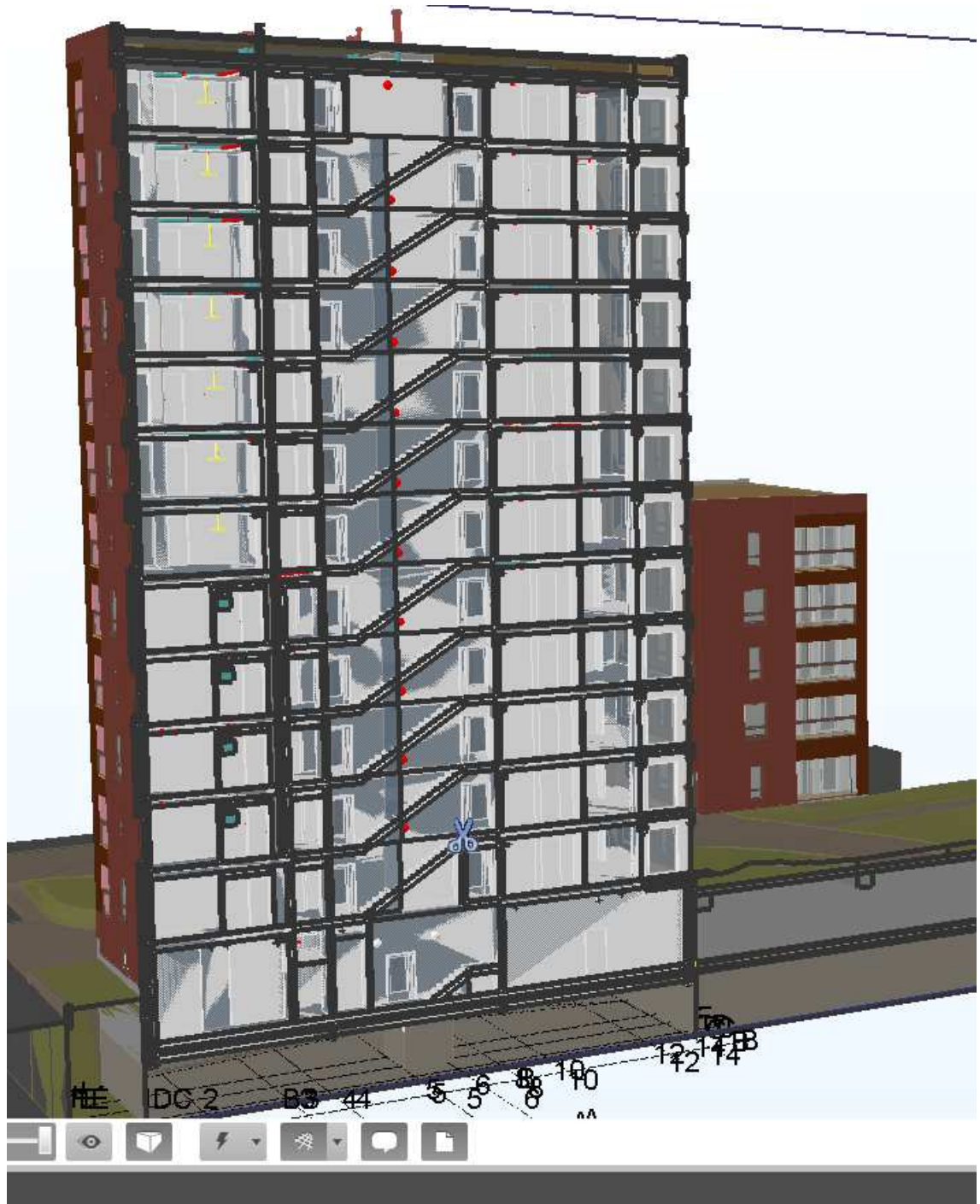
Liite 1. Tekla BIMsight, IFC-mallin leikkauskuva
