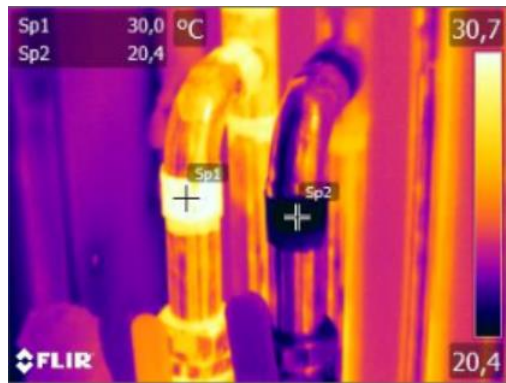
Kuva 19. Autotallin piirin jäähtymä on 9,6 [4].
