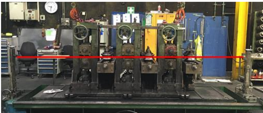
Kuva 8. Kasetin linjaus rullahuollossa, punainen viiva kuvaa linjauslankaa. (Kuva: Esa Isopahkala 2018)
