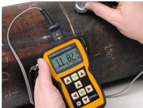
KUVA 11. Putken ultraäänipaksuusmittaus. (kuva: LVV-kuntotutkimusopas 2013, 85)
