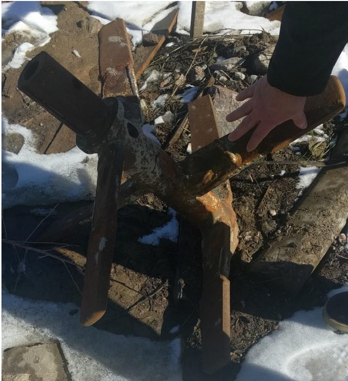
Kuva 4. Sekoitinkärki, jossa on 3 tasoa sekoitusteriä ja 30 mm syöttöaukko sideaineelle
