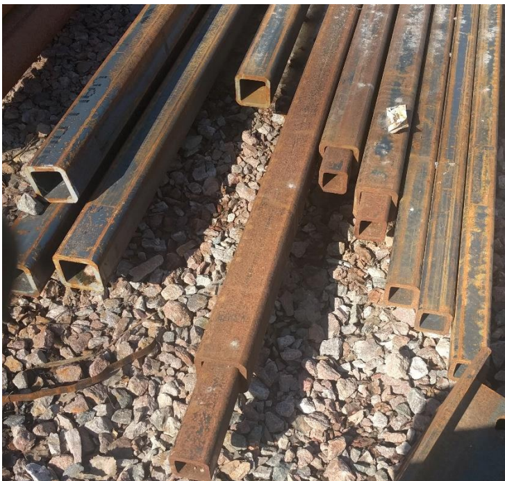
Kuva 5. Sekoitustankoina toimineita teräsputkia. Isomman putken leveys 100 mm ja teräksen paksuus 15 mm. Sisemmän putken leveys 70 mm ja teräksen paksuus 10 mm.
