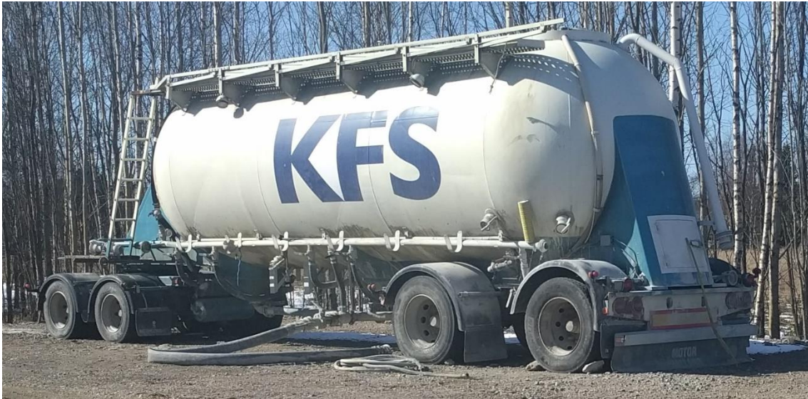
Kuva 3. Varastointisäiliö, josta ”possu” noutaa sideainetta. Tavarantoimittaja täyttää säiliön säännöllisesti. Esim. kerran viikossa.
