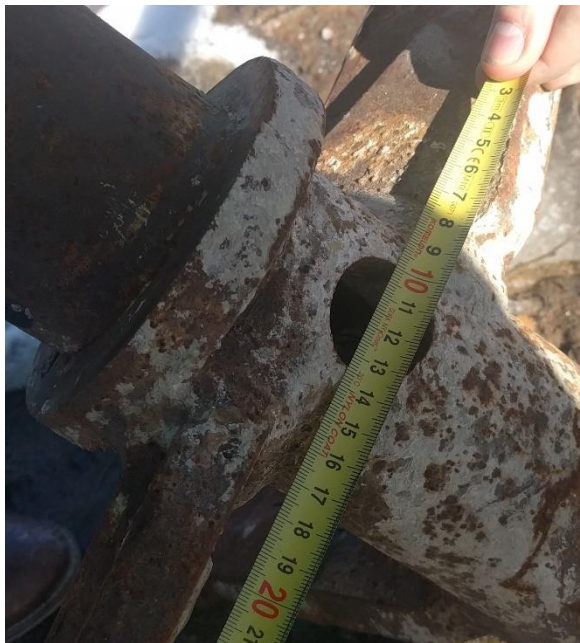
Kuva 6. Suutinaukon koko ja sijainti sekoittimessa.
