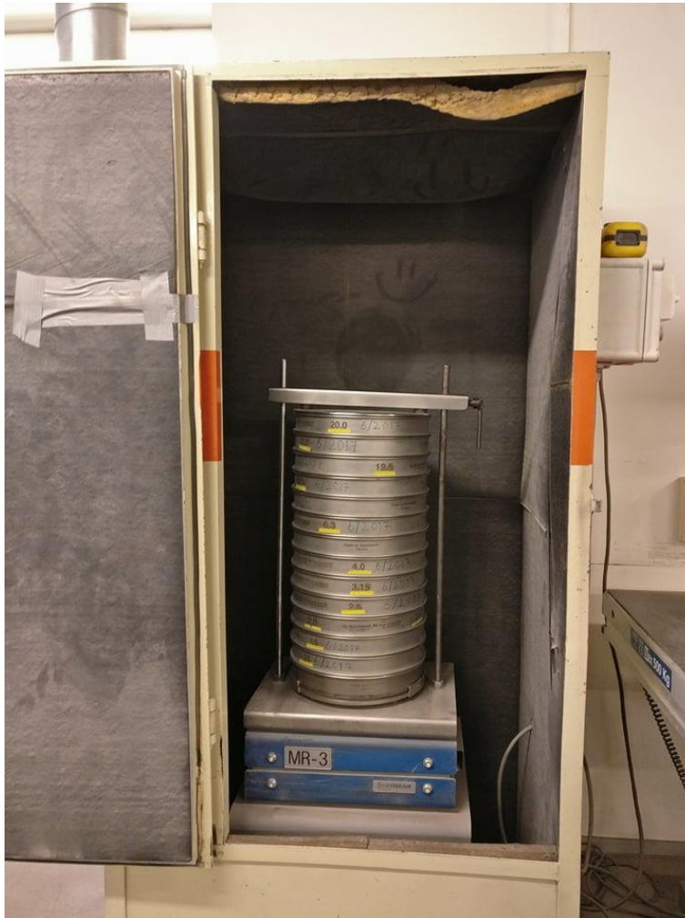
KUVA 5. Scanteknikin tärykaappi ja MR-3 tärytin
