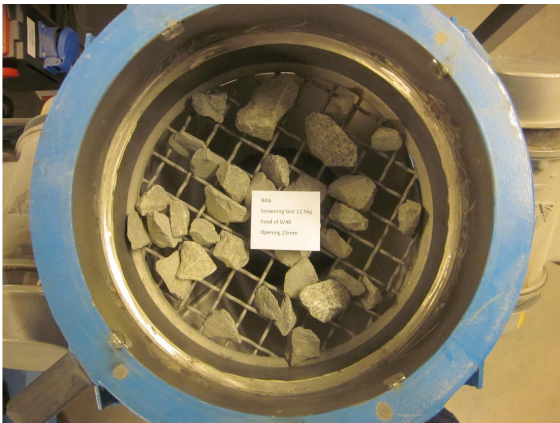
KUVA 13. 12,5 kg:n näytteen ylite ajon jälkeen 25 mm:n seulalla
