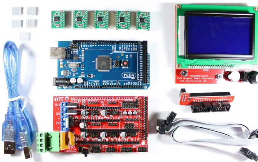
KUVA 3. RAMPS 1.4 3D-tulostimen ohjauspaketti (9)
