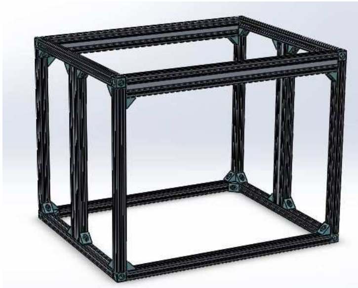
KUVA 7. Rungon kokoonpanon 400 x 400 x 500 mm:n 3D-mallinnus
