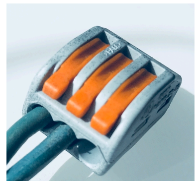
Kuvio 13. Wago-liitin. Molemmat johdot helposti irrotettavissa, mutta päältä päin on mahdoton sanoa, kumpi johdoista on irrotettaessa jännitteinen ja kumpi ei (Brelh 2018)
