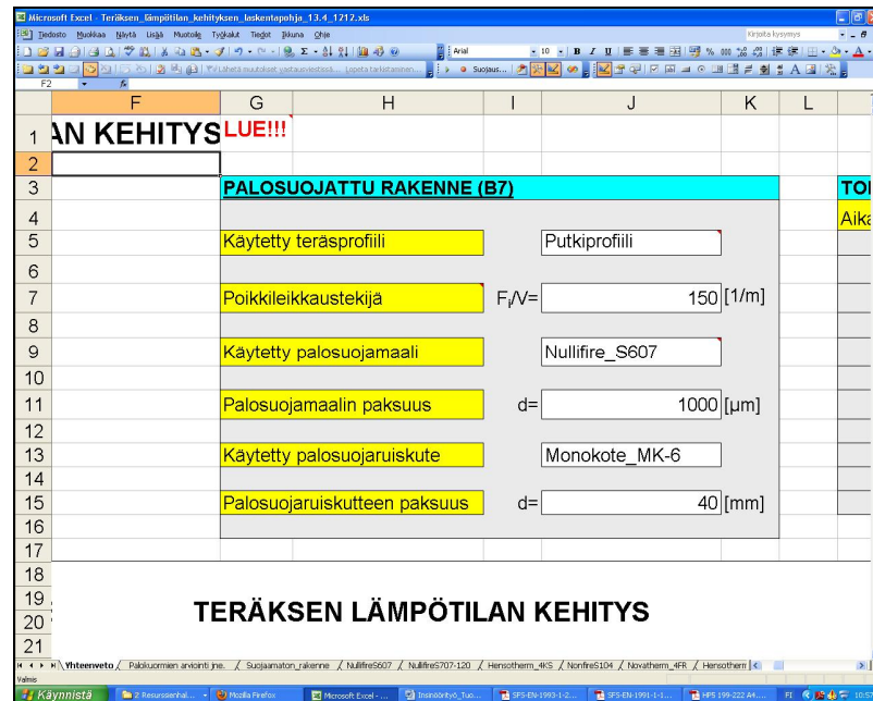
Kuva 13. Palosuojatun rakenteen lähtötiedot laskentapohjassa
