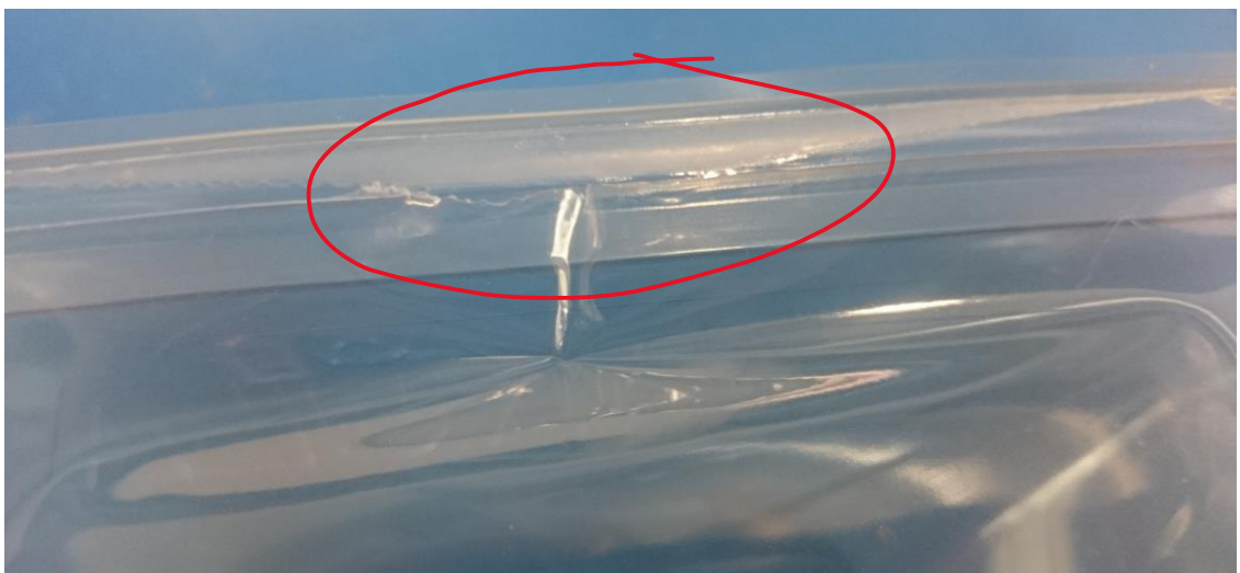
Kuva 26. Rasian valmiiksi auki oleva sauma
