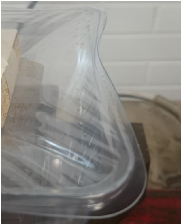
Kuva 27. Rasian suureunojen taipuminen painamisen johdosta
