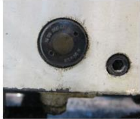
4.2 Tarkista kelkkavaihteiston ja johde öljyn määrä kelkassa olevasta silmästä ja lisää tarvittaessa
