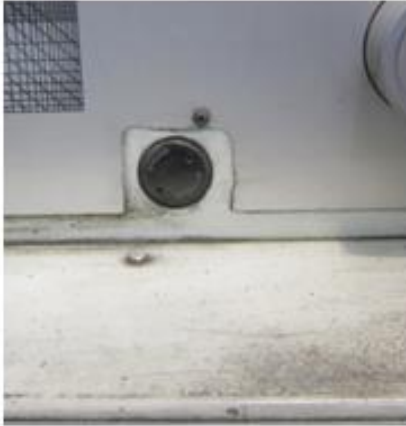
4.1 Tarkista karalaatikon öljynmäärä koneen etupuolella olevasta silmästä
