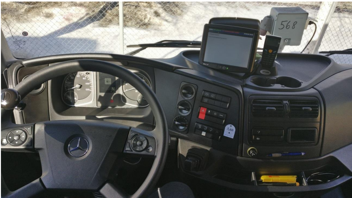
KUVA 10. Mercedes-Benz-kuorma-autoon asennettu kosketusnäyttö ja viivakoodinlukija
