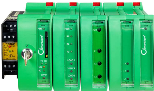
KUVA 4. Tievalaistuskeskukseen asennettavat FC-moduulit (7, s. 7)
