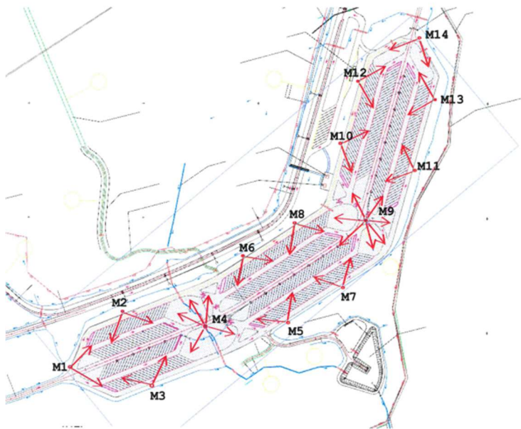
KUVA 9. Alueen mastojen sijainti lohkoilla (7, s. 28)
