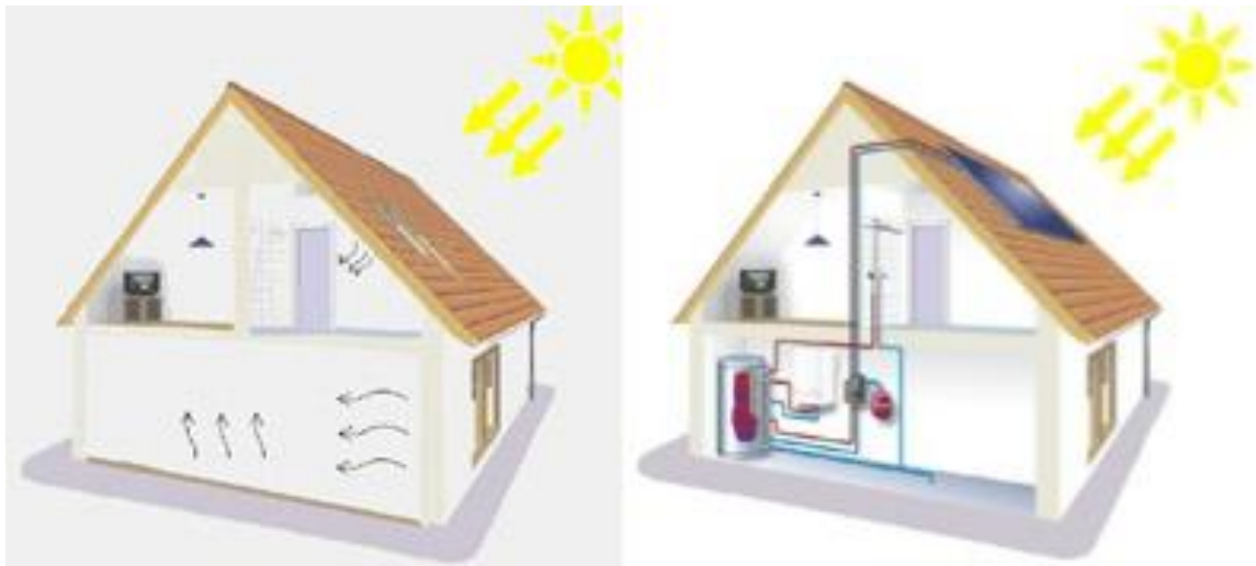
Figur 1. Princip för passiv- (vänster) och aktivsolvärme (höger). [23]
