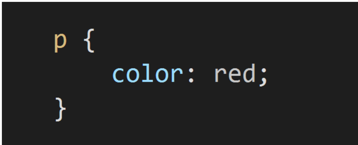
KUVIO 5. CSS-ohjeistus, jossa kaikkien ”p”-elementtien fontin väriksi määritellään punainen (Mozilla Developer Network n.d., muokattu.)
