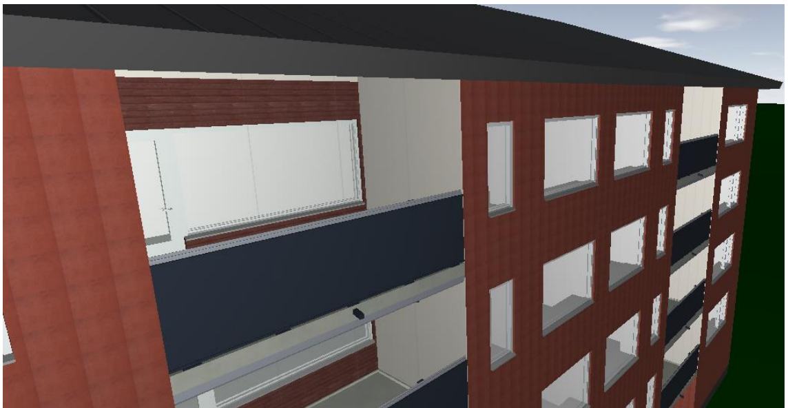
Kuva 3. Mallitalon sisäänvedetty betoniparveke, jonka seinän taustaverhouksena on käytetty kuusipuuta ja kaide on valmistettu kuumasinkitystä teräksestä [1].
