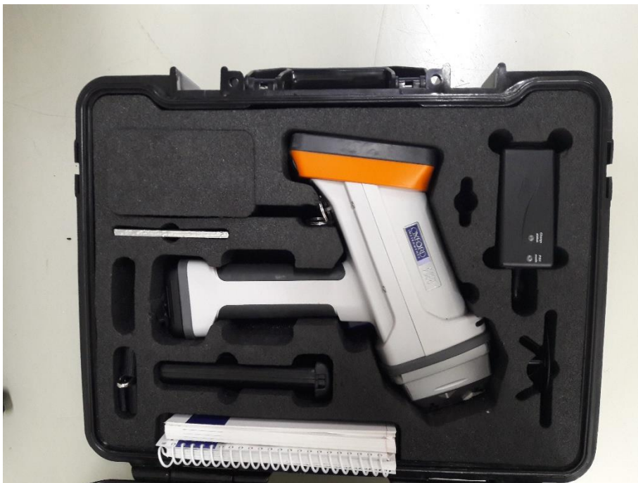
Bild 6. Metropolias XRF-apparat av märket Oxford Instruments, modell X-MET 7500.
