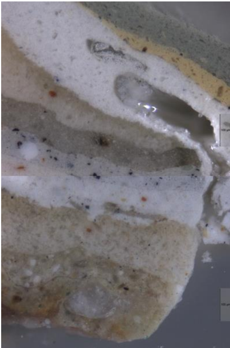
Bild 9. Mikroskopbild G2.1 200218 består av två delar eftersom färgsnittet var så tjockt. Bilden visar ett färgsnitt från fasaden på gavelväggen som vetter in mot gården. 100x förstoring.
