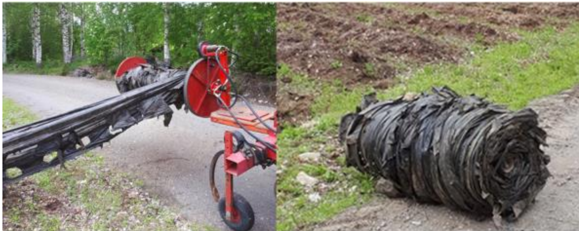
KUVA 4. Muovin kelauskone sekä kelattu muovirulla (Markkanen 2018-06-20.)
