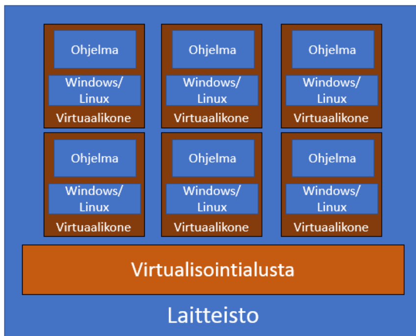
Kuva 2. Tyyppin 1 virtualisointialusta (Portnoy 2012, 22.)
