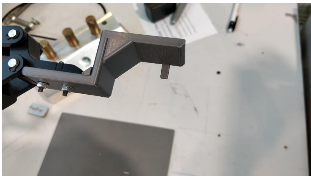
Kuva 20. Uusi malli 3D-tulostettuna ja kiinni tarttujassa.
