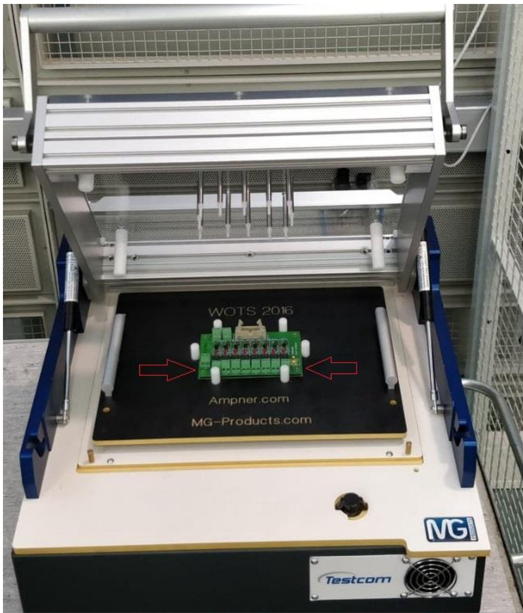
Kuva 16. Punaiset nuolet osoittavat mistä kohtaa piirikorttia oli tarkoitus tarttujalla tarttua.
