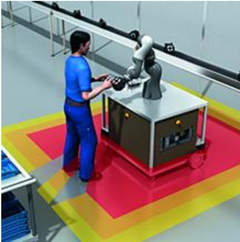
Kuva 41. S300 mini trivalaserskannerin mittausalue.
