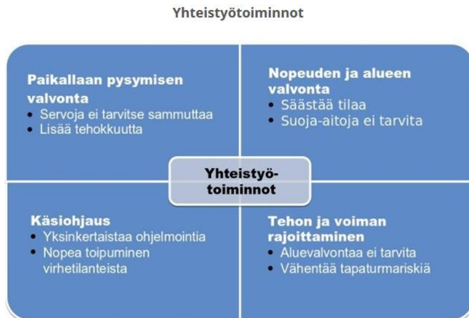
Kuva 1. Yhteistyörobotiikan neljä yhteistyötoimintoa.
