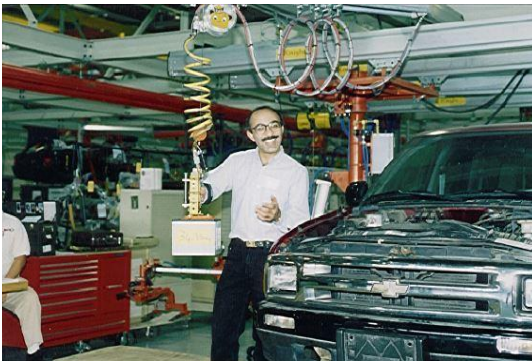
Kuva 2. UC Berkleyn tutkijoiden kehittämä z-nostin General Motorsin tehtaalla.
