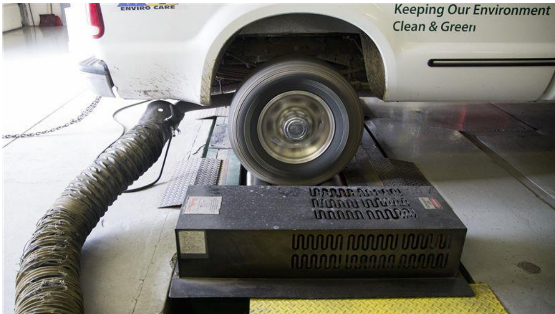
Kuva 11. Pakokaasupäästöjen mittaus dynamometrissa (Diesel emissions testing. 2015)
