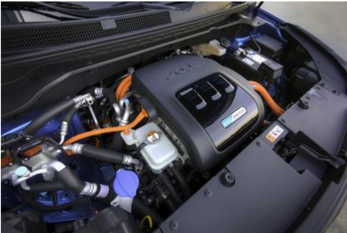
Kuva 7. Kia Soul -henkilöauton moottoritila, jossa korkeajännitekaapelit ovat merkitty oranssilla kuorella
