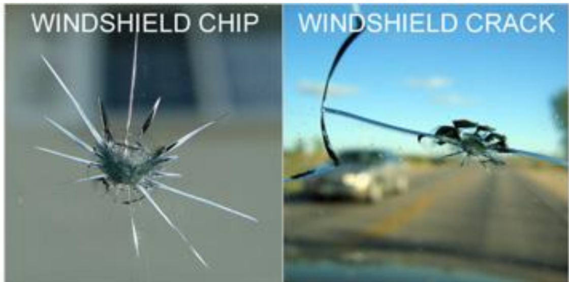
Kuva 9. Kiveniskemä (vasemmalla) ja halkeama (oikealla) (G zone auto glass 2016.)
