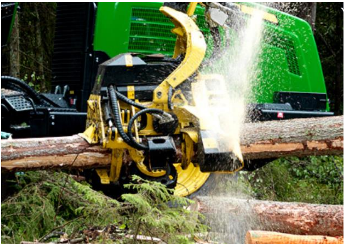
KUVA 1. John Deere H480C harvesteripää tekemässä katkaisusahausta (John Deere 2018f)
