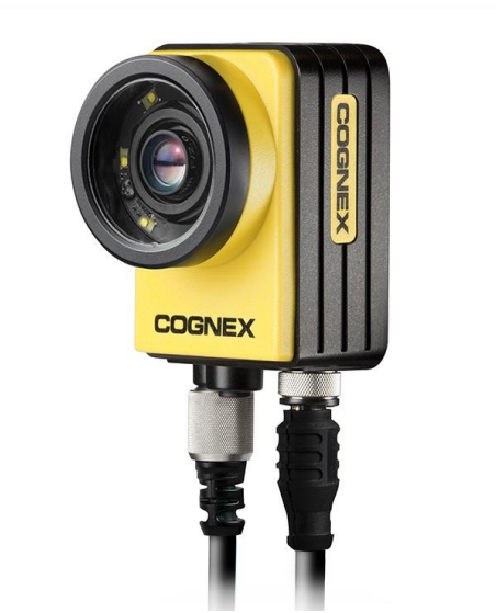
KUVA 8. Cognex In-Sight 7400 -väriälykamera (Visionlink)
