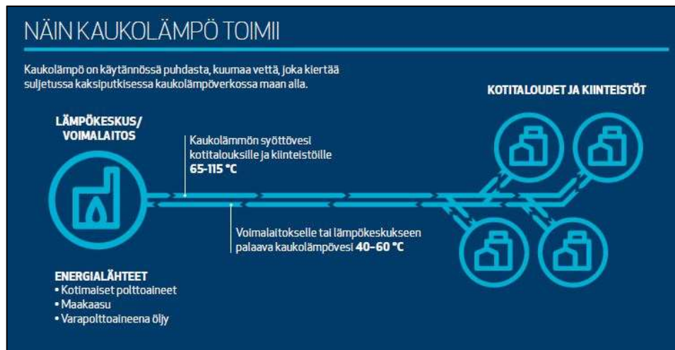
Kuvio 2. Kaukolämmön toimintaperiaate (Elenia 2018)
