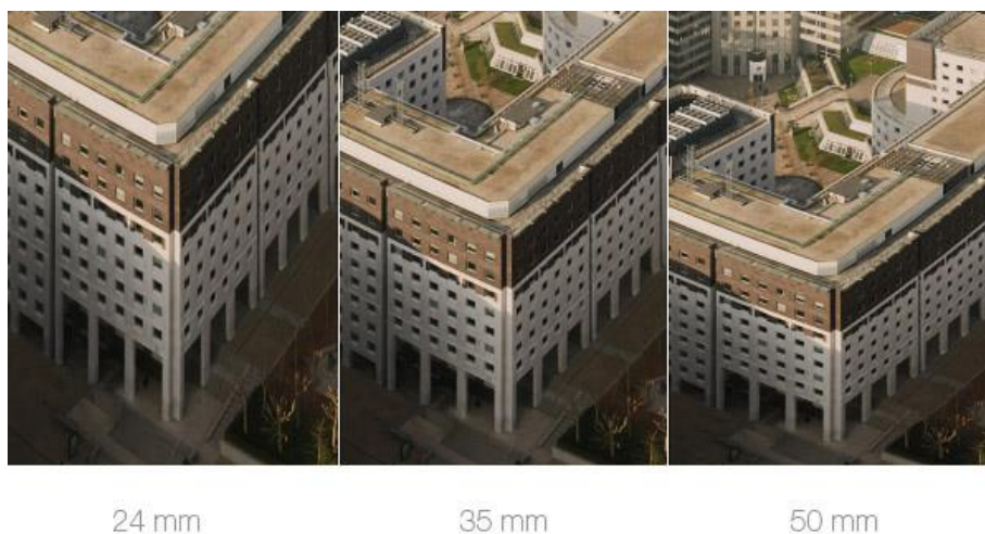
Kuva 12. 24mm ja 50mm polttovälillä olevien objektiivien ero vääristymissä (Frich 2018c)
