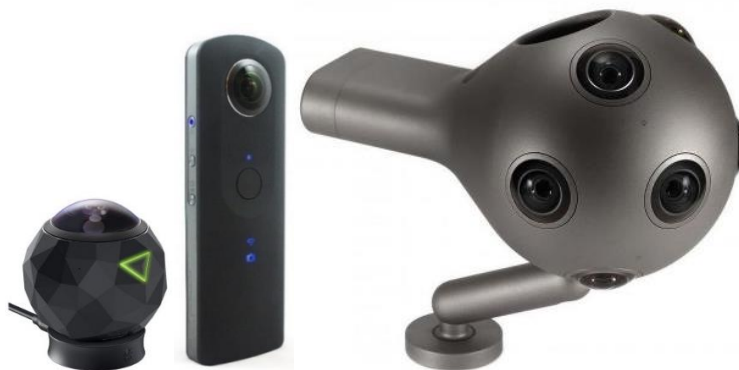
Kuva 14. Yksi-, kaksi- ja monilinsinen 360-kamera (360-fly 2017; Ricoh 2018; Nokia 2017)
