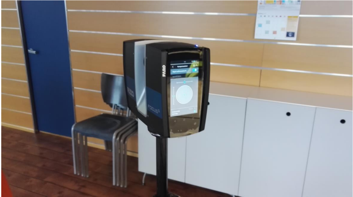
Kuva 7. Faro Focus S-70 -laserkeilain
