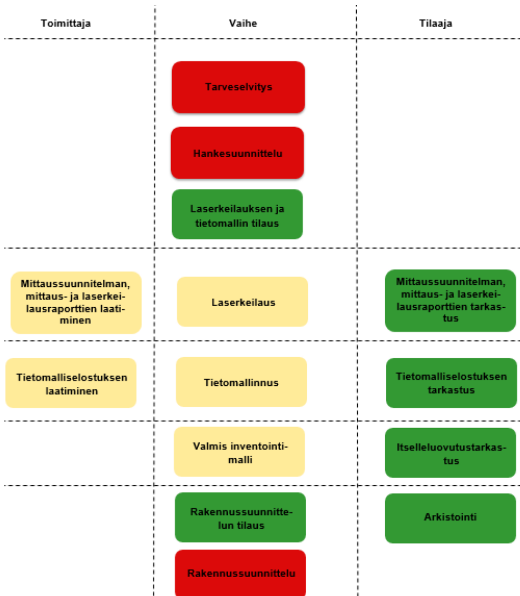
Kuva 9. Laserkeilaus- ja tietomallinnushankkeen prosessikaavio
