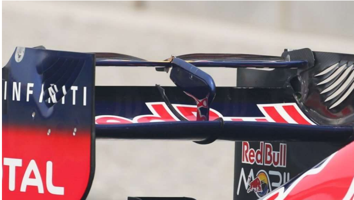
Kuva 2. Red Bull Racing DRS-järjestelmä (Formula One 2018).
