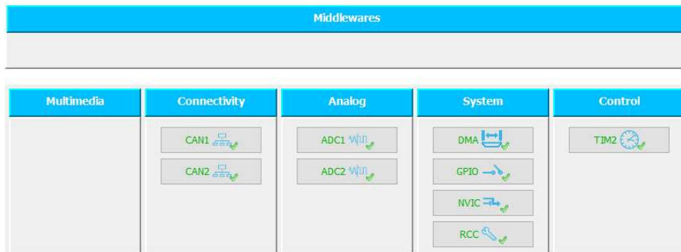
Kuva 30. STM32Cube Configurations -välilehti.
