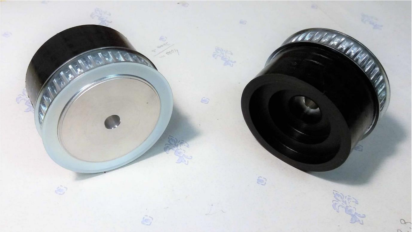
KUVA 9. Kuvassa ovat sorvatut välilaidat ja vetopyörät
