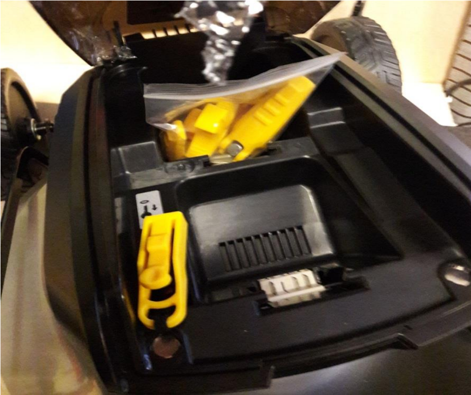
KUVA 4. Ruohonleikkurin 40 voltin akun/akuston akkutila
