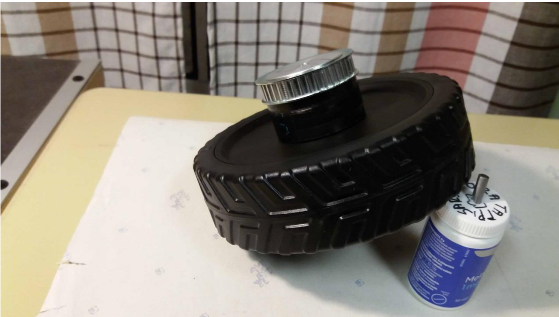
KUVA 10. Vetopyörä, välilaiippa ja ruohonleikkurin pyörä
