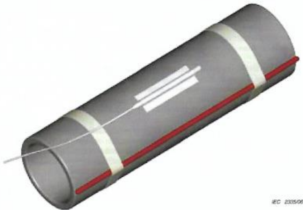
Kuva 10. Anturin tyypillinen asennus (SFS-EN 60079-30-2, 42).
