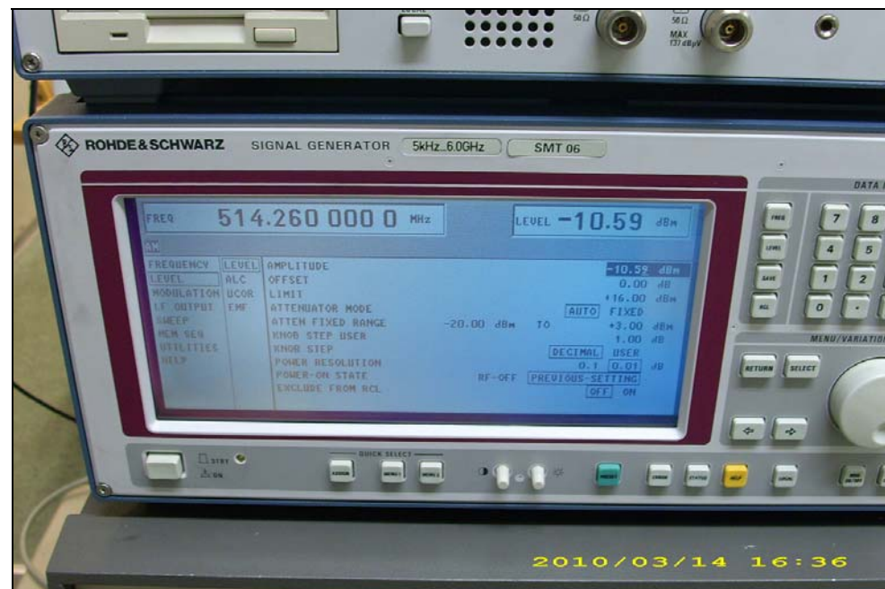
Kuva 24. Jänniteinjektio-tilanne verkkojohtoon : häirintägeneraattori taajuudella 514,26 MHz ja 10 V/m:n kentänvoimakkuuden häiritsevyytensä vastaavalla antotasolla -10,59 dBm
