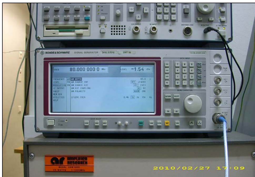
Kuva 51. Häirintägeneraattori koko työn ajan, signaaligeneraattori Rohde&Schwarz Signal Generator 5 kHz...6,0 GHz SMT 06, s/n 83397/002
