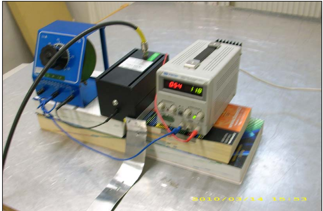
Kuva 19. Jänniteinjektiotilanne liitäntäjohtoon : testattavan laitteen häiriintyminen taajuudella 393,11 MHz kuvan 18 esittämällä antotasolla, epävakaata näyttämä keskimäärin 11,9 V (kuvan ottohetkellä sattumalta 11,8 V)
