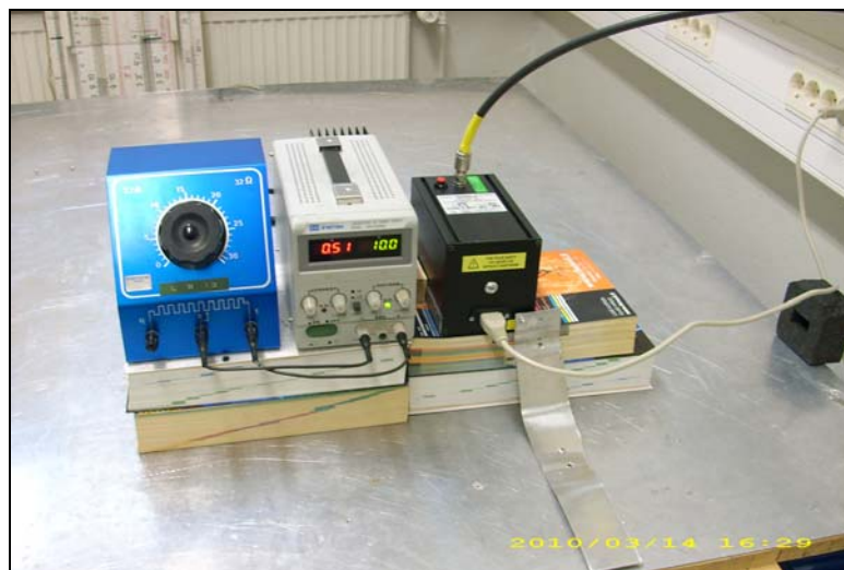
Kuva 13. Jänniteinjektio verkkojohtoon , koejärjestely kytkentäelintä CDN L-801 M2/M3 käyttäen. Vasemmalta reostaatti, jännitelähde ja kytkentäelin.
