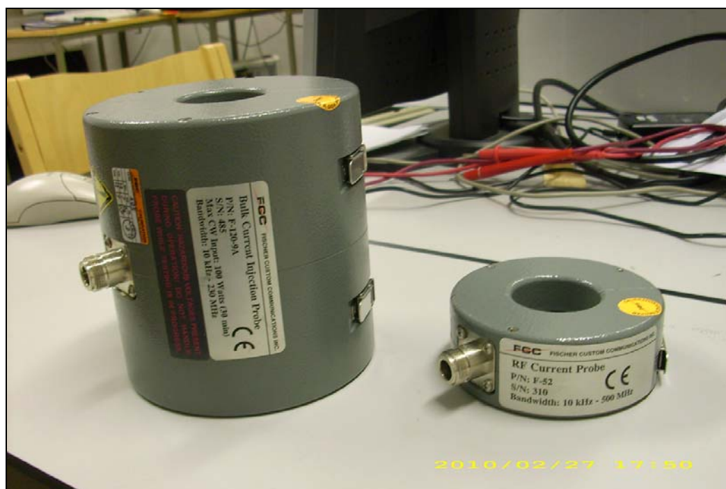
Kuva 47. Virtamuuntajat, vasemmalla Bulk Current Injection Probe ja oikealla RF Current Probe. Molempien valmistaja on Fischer Custom Communications Inc.
