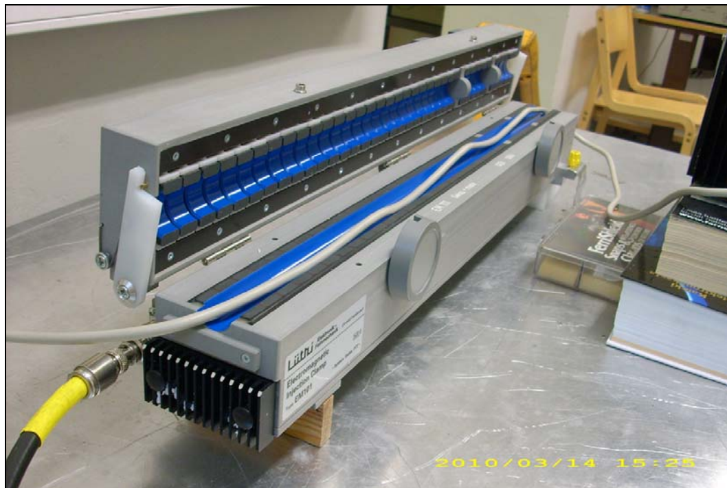
Kuva 49. Virtainjektointilaite EM 101 avattuna johtimen asettelemiseksi paikalleen Virtainjektiotapauksissa mittaussilmukkaan (RF Current Probe) indusoituvaa jännitettä mitattiin Hameg-spektrianalysaattorilla, malli HM 5014-2 (kuva 50).
