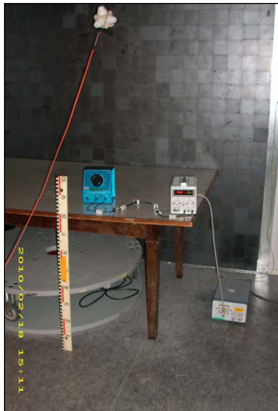
Kuva 9. Testausstandardin mukainen säteilevän häiriön koejärjestely. Kattoon on ripustettu kentänvoimakkuusanturi, jonka informaatio tuodaan valokuidulla huoneen ulkopuolelle. Testattavan laitteen korkeus on täsmälleen oikea, 80 cm lattiasta. Laitteet vasemmalta oikealle: säätövastus (reostaatti), ferriitein varustetut ja tarkalleen metrin mittaiset kytkentäjohdot, testattava laite eli jännitelähde tässä työssä ja lattialla keinoverkko (LISN), josta lähtee tarkalleen metrin pituinen syöttöjohto testattavalle laitteelle.
