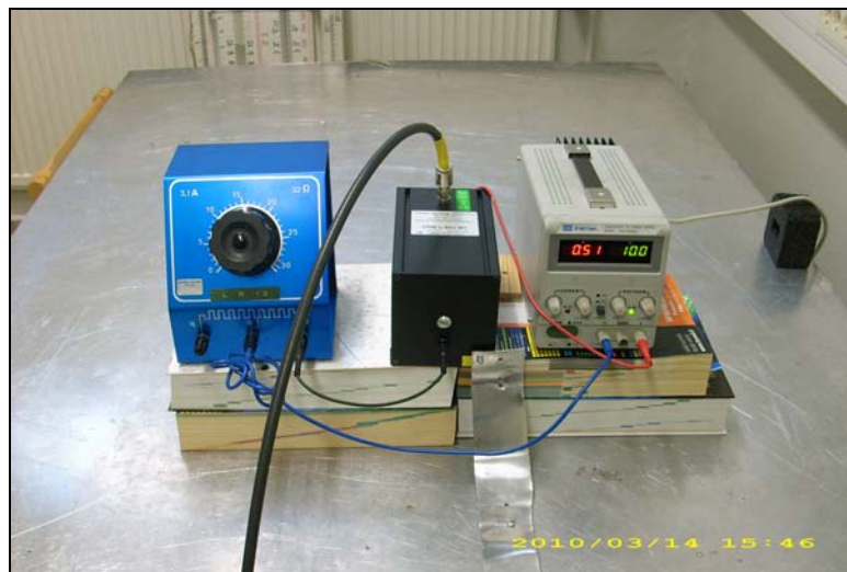
Kuva 12. Jänniteinjektio liitäntäjohtoon , koejärjestely kytkentäelintä CDN L-801 M1 käyttäen. Vasemmalta reostaatti, kytkentäelin ja jännitelähde. Huomiota kiinnitettiin kytkentäelimen kunnolliseen maadoitukseen.
