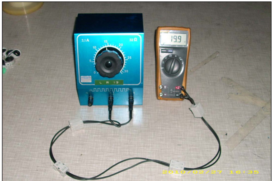
Kuva 38. Säätvastus eli reostaatti, kuvassa myös säädön asettelu kohdalleen Fluke-yleismittarilla
