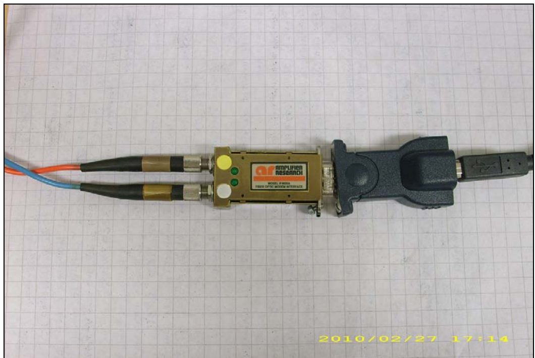
Kuva 44. Optiikkamuunnin: muunnin, joka muuntaa valokuituinformaation tietokoneen ymmärtämiksi jännitetasojen vaihteluiksi eli biteiksi.
