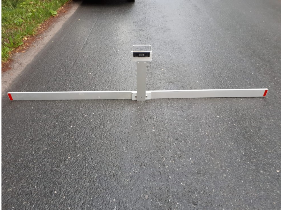
Kuva 11. Urasyvyyden mittaamiseen käytetty oikolautu.
