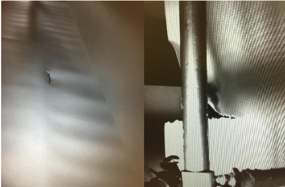
Kuva 12 Katkokamerajärjestelmällä kuvatut ratakatkon aiheuttajat; reikä massaradassa ja reuna risa
