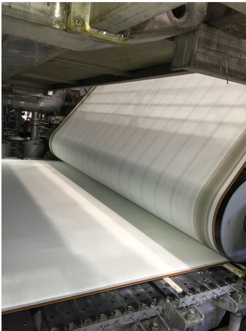
Kuva 14. Yksi halutuista kohteista oli yläviiranulostulo hoitopuolelta
