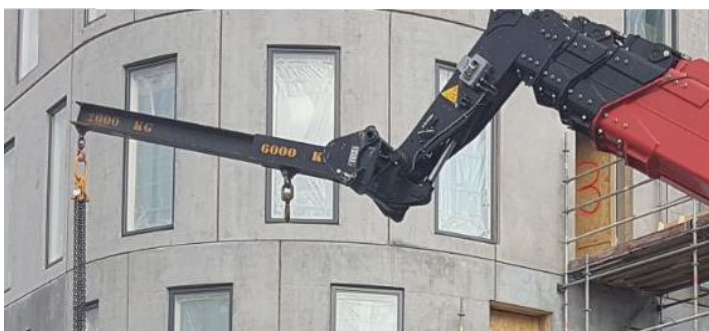
Kuva 2. Kurottajaan kytketty lisälaitte. Jib-varsi kahdella nostokoukulla.
