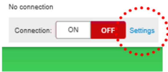
KUVA 6. Asetuksista määritellään PC:n ja suojareleen väliset yhteysasetukset.
