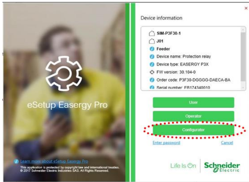
KUVA 10. Laitteen informaatio-ikkunasta valitaan kirjautumisen käyttäjä-taso sekä nähdään skannatun laitteen tiedot ja tilauskoodi.
