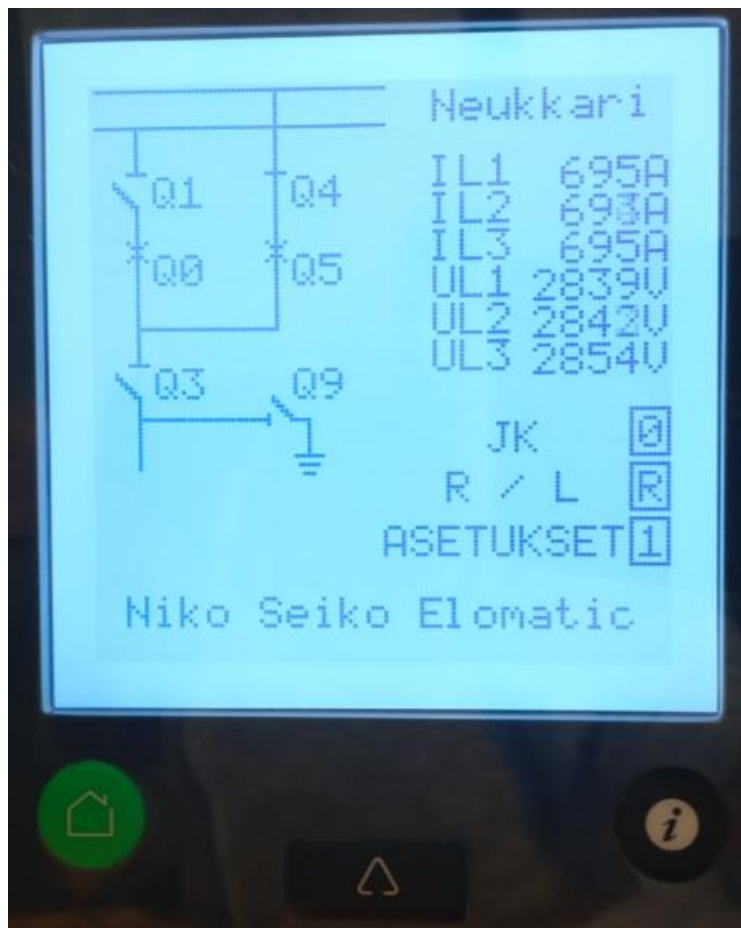
KUVA 17. P3-Suojareleeseen luotu näyttö mimiikka-editorilla. Kuvassa näkyvät virta- ja jännitearvot on tuotettu demoalustalla olevalla potentiometrisäätimellä, joten mittausarvoja ei tule tulkita piiriin realistisina.
