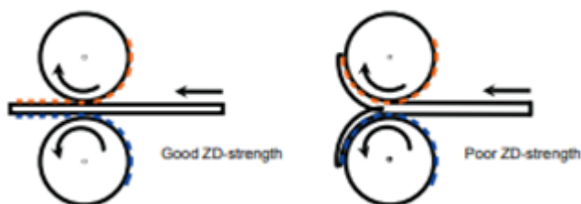
KUVA 2 Delaminoituminen painotapahtumassa (ABB, 2017)
