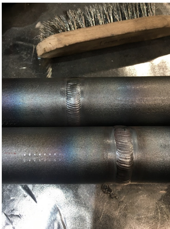
Kuva 16. Ylempi hitsi on hitsattu orbitaalilla ja alla käsinhitsattu
