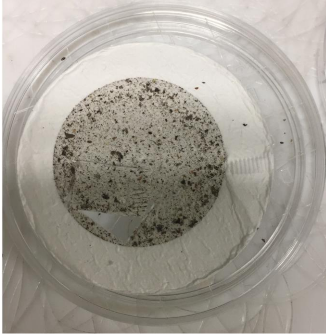
Kuva 21 Tasainen harmaa väri suodattimen näytealueella, mutta pinnalta löytyy irtonaista ainetta (mustat pilkut).
