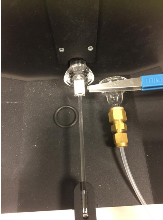
Kuva 10 Näytteesyöttäjä (pitkä lasinen tikku) jolla suodatinpalanen asetetaan näyteuuniin.
