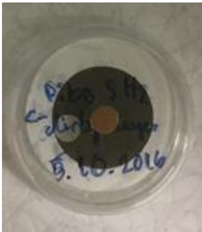
Kuva 22 Suodattimen musta näytealue ja polton jälkeinen näytepalanen (oranssi ympyrä).
