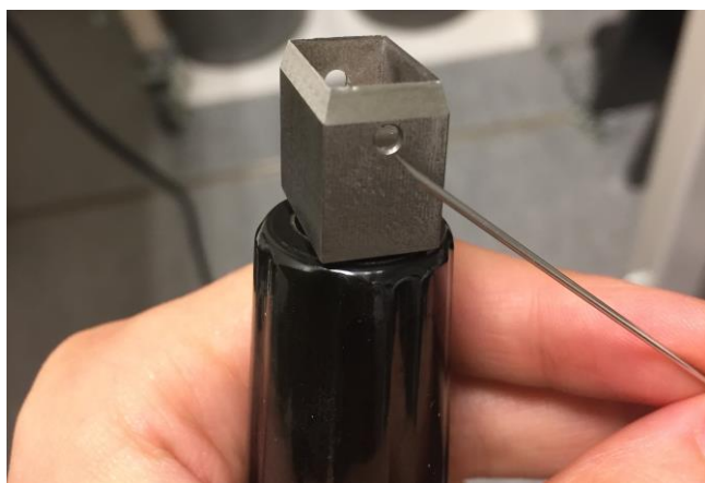
Kuva 18 Pieni kolo, josta näytepalan voi irrottaa neulalla
