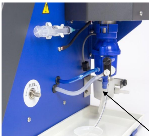
Kuva 3. U-Tube-putkisto nuolen osoittamassa kohdassa
