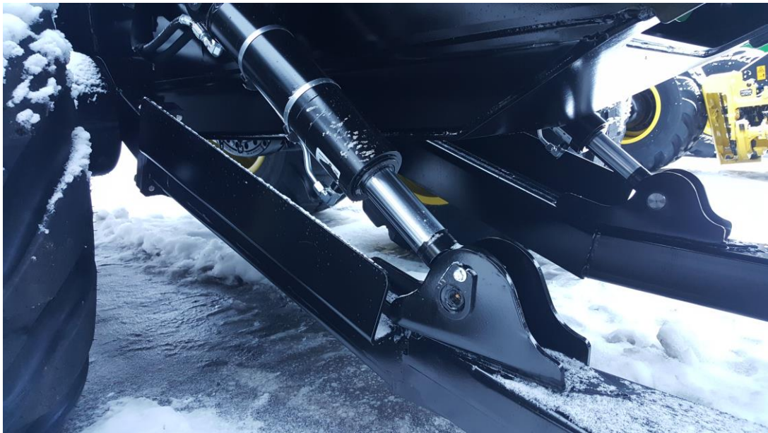
Kuva 8. Asennettu puskulevy (Kuva: Janne Mourujärvi).
