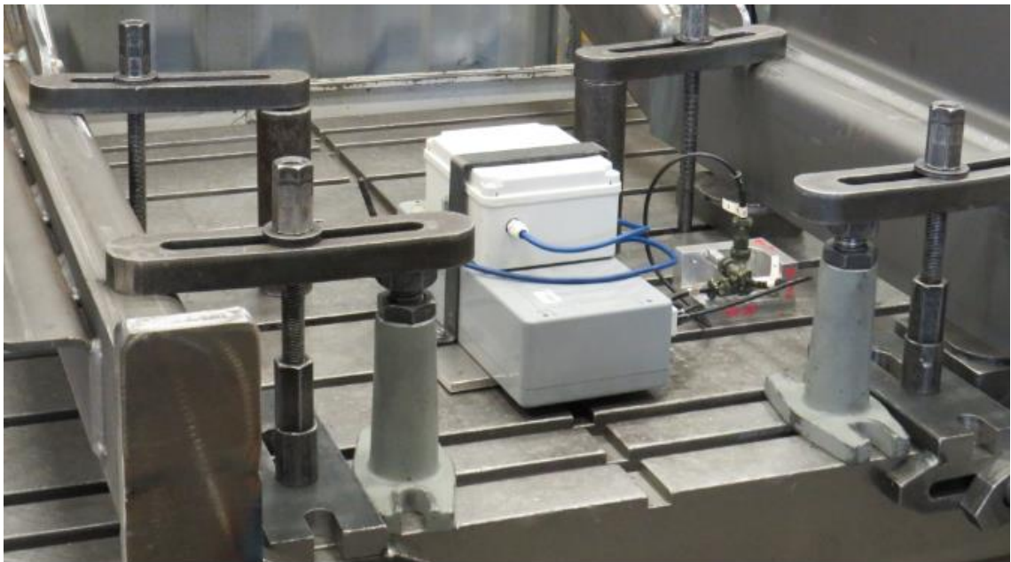
Kuva 6. Värähtelyn mittaus alkuperäisellä kiinnityksellä (Kuva: Kari Mönkönen).
