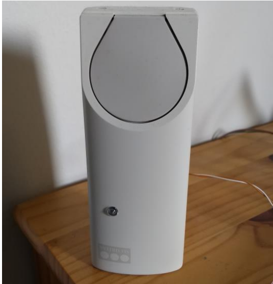
Kuva 3. Securitaksen liiketunnistin. Kuvassa väärin päin, laite asennetaan kattotasoon, jolloin harmaa sensoriosa osoittaa viistoon alaspäin.
