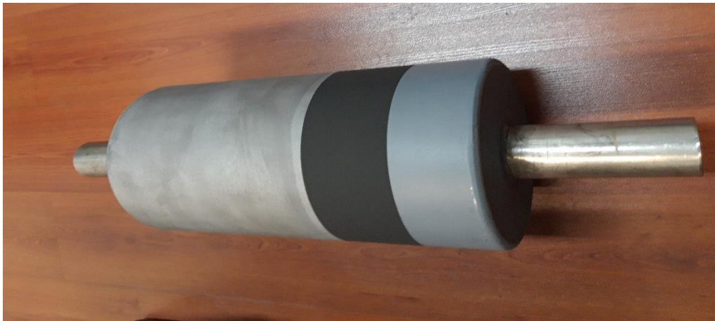
Kuva 2. Vasemmalta: Hiekkapuhallus, vulkanointiliima ja primer.
