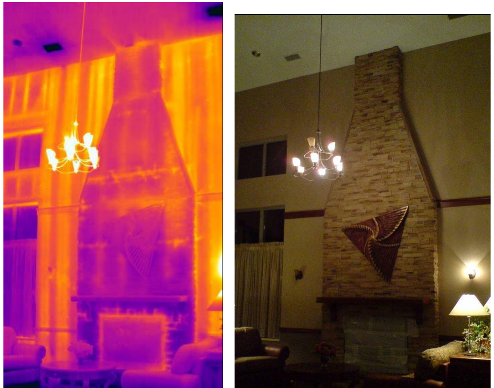
Kuva 25. Amerikkalaisen pientalon piipun ympäristön ilmapuodot ja kylmäsillat ulkoseinässä [23, s. 268.]
