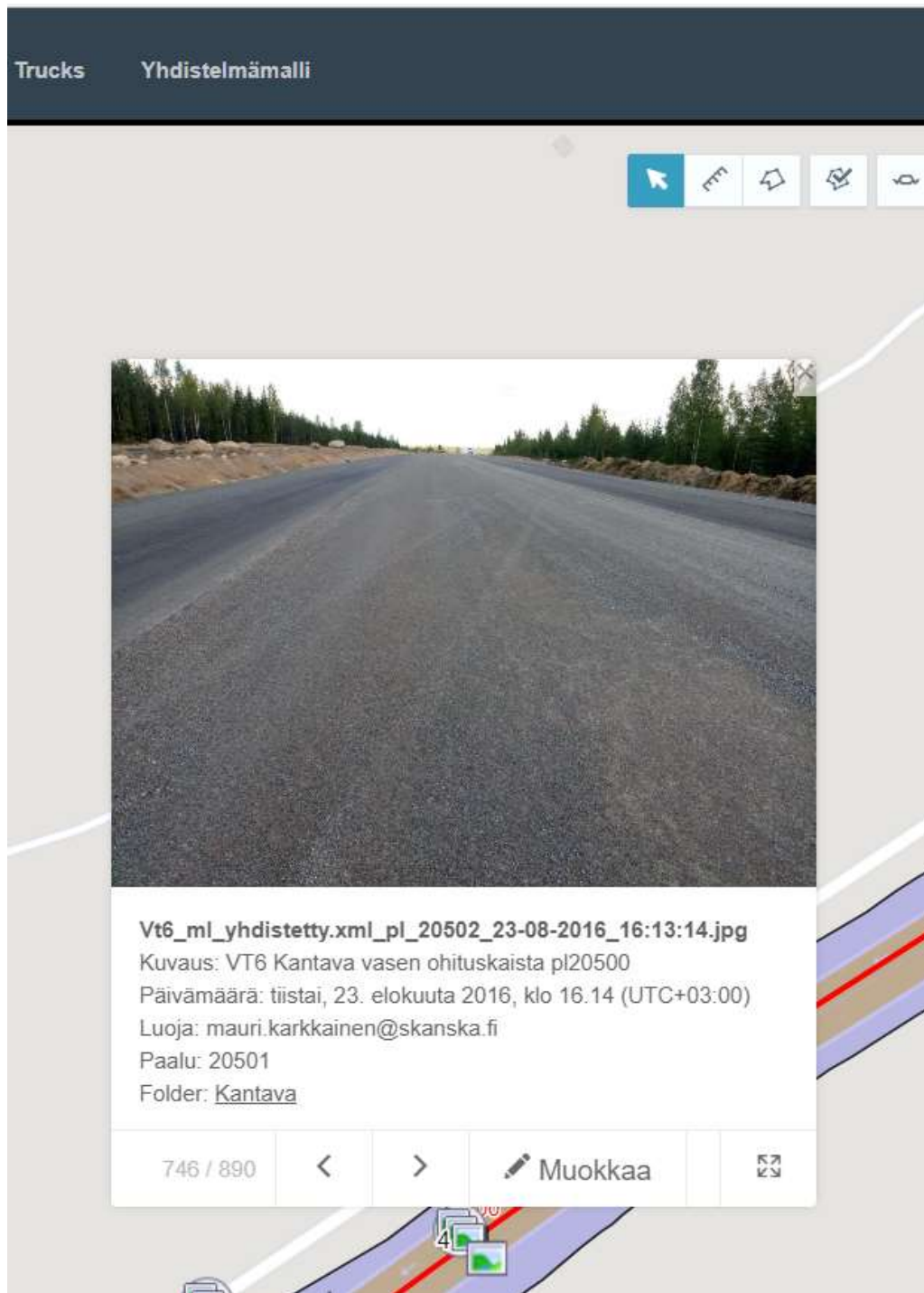
Kuva 9. Infrakit-kuva jossa kerros-, kaista- ja paaluerittelyt (Skanska Infra Oy)
