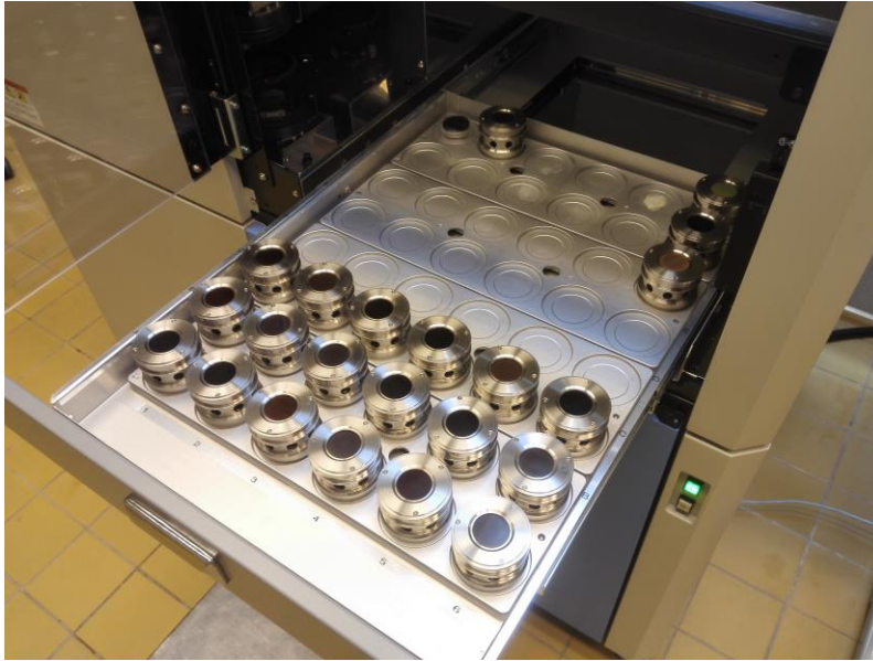
Kuva 20. Kalbrintinäytteitä valmiina ajoon Rigakun ZSX Primus II -laitteessa.
