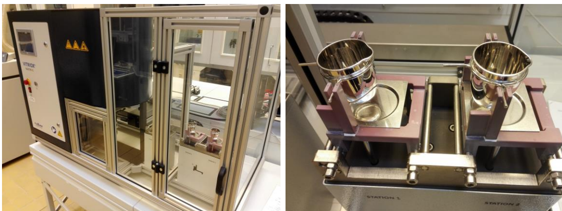
Kuva 17. Vasemmalla Fluxana Vitriox Electric -sulatelaite. Oikealla platinaupokkaat ja -muotit.
