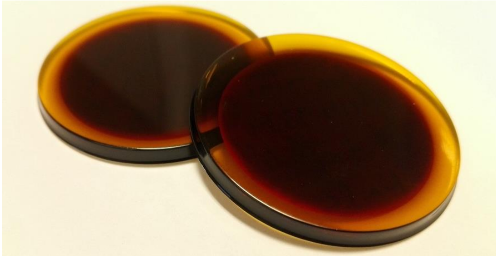
Kuva 16. Fluxana Vitriox Electric -sulatelaitteella valmistettuja sulatenappeja.
