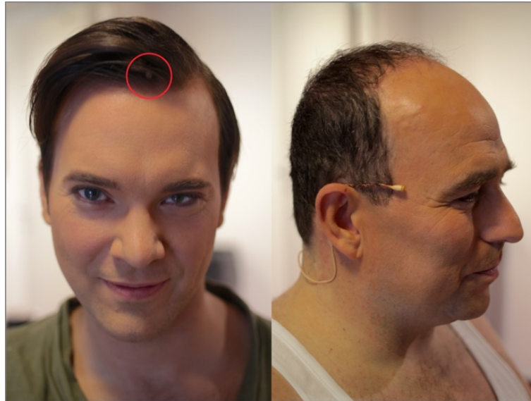
Kuvio 17. Vasemmassa kuvassa DPA4061 -mikrofoni piilotettuna hiusrajassa. Oikealla näyttelijä varustettuna ear-rig-mikrofonilla.
