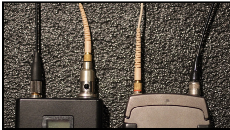
Kuvio 3. Kuvassa vasemmalla microdot-liitin mini-XLR-adapterilla ja oikealla microdot-liitin suoraan kiinnitettyä lähettimeen ilman adapteria.
