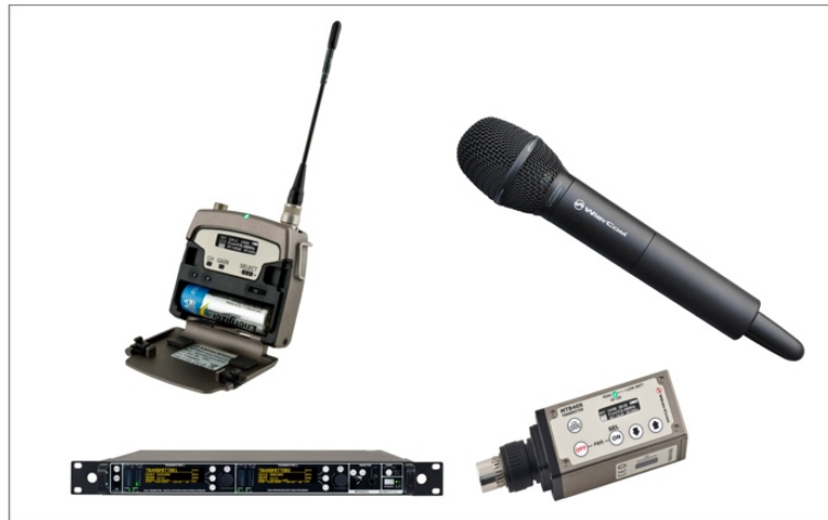
Kuvio 4. Kuvassa Wisycom-merkkisiä lähettämiä. MTP41 vyölähetin, MTH400 kapulälähetin, MTK952 räckkilähetin ja MTB40S tulppälähetin.
