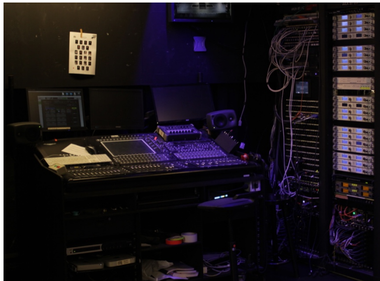
Kuvio 18. Kuvassa Svenska Teaternin Monitorland ja WL-räkki jossa mikkikalle majoilee suurimman osan esityksestä, monitoroiden äänijärjestelmää ”Stockmann Stockmann” -esityksessä.
