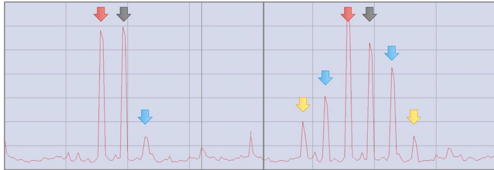
Kuvio 11. Vasemmassa kuvassa lähettimet ovat noin 2 metrin etäisyydellä. Punaisella nuolella merkattu lähtetimen signaali RF-spektrissä on taajuudella 487.900 MHz, ja mustalla nuolella toisen lähtetimen signaali taajuudella 489.700. Sinisen nuolen kohdalla voi jo havaita kolmannen kerrannaisen IM-tuotteen. Tämä tuote on joka tapauksessa niin heikko, ettei se vaikuta muiden langattomien järjestelmien toimivuuteen. Oikeanpuolisessa kuvassa samat lähettimet ovat vierekkäin vain parin senttimetrin päässä toisistaan, ja RF-mittaus antaa osviittaa siitä, kuinka IM tuotteet kasvavat etäisyyden lähettimien välissä ollessa liian lyhyt. Sinisellä merkattu kolmannen kerrannaisen ja keltaisella viidennen kerrannaisen IM-tuotteet, jotka jo saattavat häiritä muuta langatonta toimintaa. Voi myös huomata, että itse valittu kantotaajuuden signaali on heikentynyt huomattavasti.
