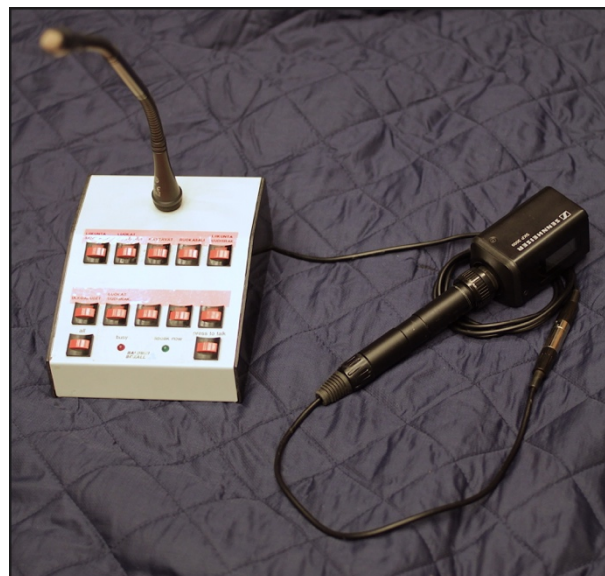
Kuvio 16. Sennheiserin plug-on-lähetin kytkettynä AKG:n kondensaattorimikrofoniin, joka on sisäänrakennettu lavasteeseen.
