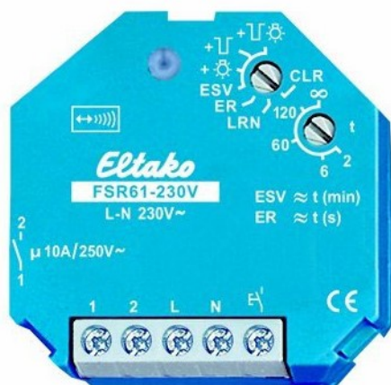
Kuva 12. Eltako FSR61-230V EnOcean-releesäädin. Säätimen koko on 45 x 45 x 33 mm.
