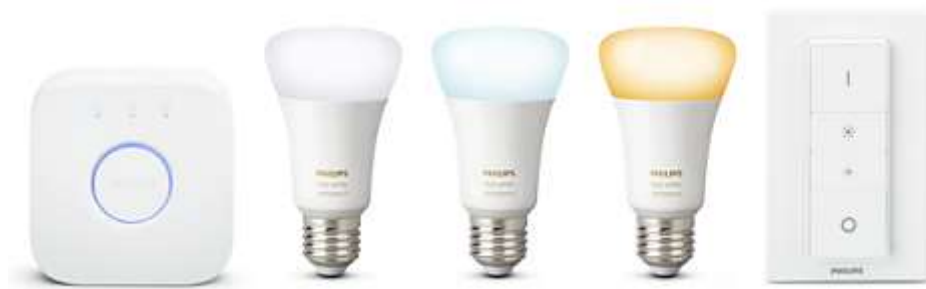
Kuva 6. Vasemmalta oikealle esitettynä Philips Hue silta, E27-kantaiset white and color ambiance polttimet ja himmennin.
