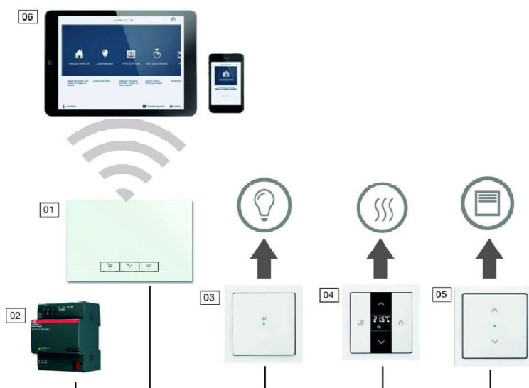
Kuva 9. Havainnekuva parikaapelilla toteutetusta järjestelmästä. Numerosta yksi numeroon kuusi on esitetty System Access Point, virtalähde, painike releellä, huonetermostaatti, anturi- tai verho-ohjain ja mobiililaitteet [25, s.8.]
